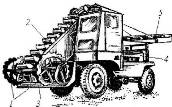
Рис. 1. Погрузчик непрерывного действия, где 1 – шнековый питатель, 2 – ковшовый элеватор, 3 – скребок, 4 – базовый тягач, 5 – скребковый конвейер
