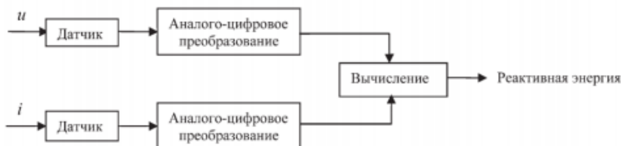
Рис. 1. Экспериментальная блок-схема измерения реактивной энергии путем аналого-цифрового преобразования величин напряжения и тока и последующей реализации математических формул реактивной мощности и энергии
