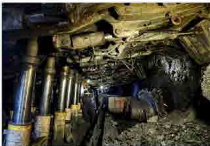
Рис.3. Механизированный очистный забой работает в лаве
