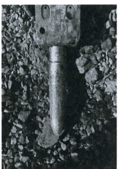
Рис. 1 Вид пики гидромолота JCB NM380 после эксплуатации
