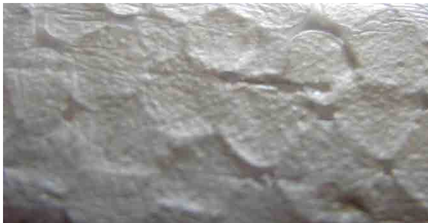
Рис. 2 – ППС с гранулами в форме многогранников
