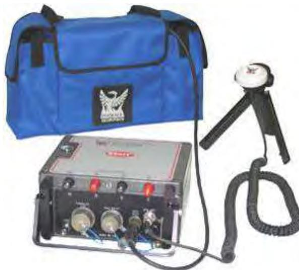
Автономные, многофункциональные регистраторы для методов АМТ, МТ, CSAMT, ЗС и ЧЭЗ, обладают малым весом, стабильностью параметров и малым уровнем шумов, надежны в эксплуатации.
