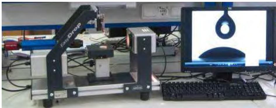
Система анализа формы капли предназначена для изучения молекулярно-поверхностных свойств жидкостей и твердых тел. Управление установкой осуществляется через компьютерную программу DSA-209. Благодаря наличию специальной видеокамеры имеется возможность определения краевых углов смачивания в динамике во времени, в том числе и для случаев времени жизни капли на изучаемой поверхности от 0,1 с.
