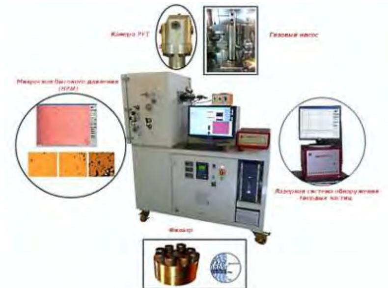
Встраиваемый модуль предназначен для анализа выпадения солей при PVT-условиях. Рабочее давление 700 бар
