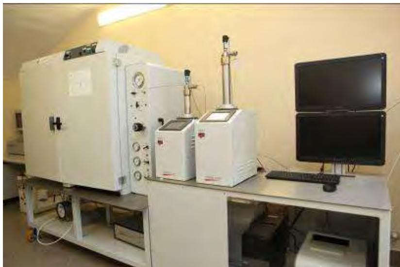
Сканер является дополнительным модулем к установке AutoFlood 700 и позволяет производить мониторинг движения флюида в керне при термобарических условиях в системе «жидкость-жидкость», жидкость-газ». Основной рабочей частью является подвижный сканер X-лучей, сканирующий керн в одной плоскости.
