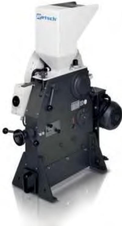
Щековая дробилка ВВ 100 используется для быстрого бережного предварительного измельчения средне-твердых, твердых, хрупких и прочных материалов.
