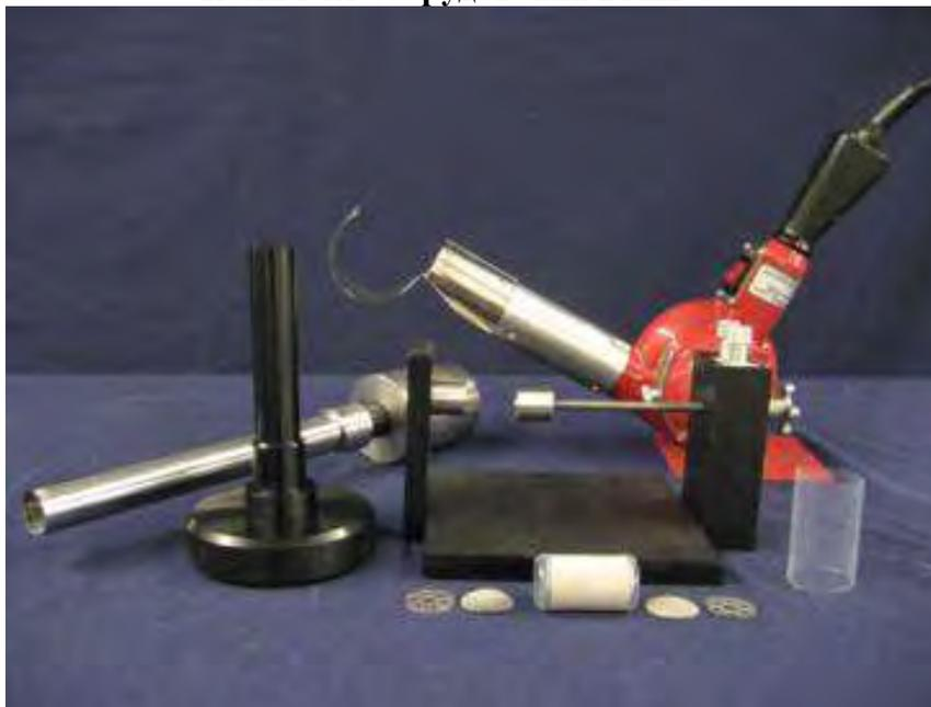
Набор для крепления рыхлых и нецементированных цилиндрических образцов керна.
