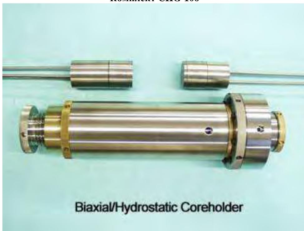
Стандартный кернодержатель Хасслера имеет три входные линии и две выходные линии для осуществления экспериментов по определению относительной проницаемости. Макс. давление обжима 680 атм, макс. температура 150 °С, макс. поровое давление 650 атм.
