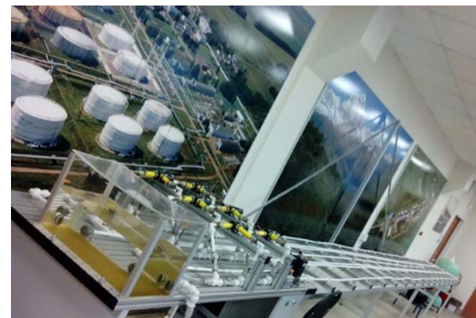
Рисунок 9 – Экспериментальный стенд трубопровода с установленным оборудованием
