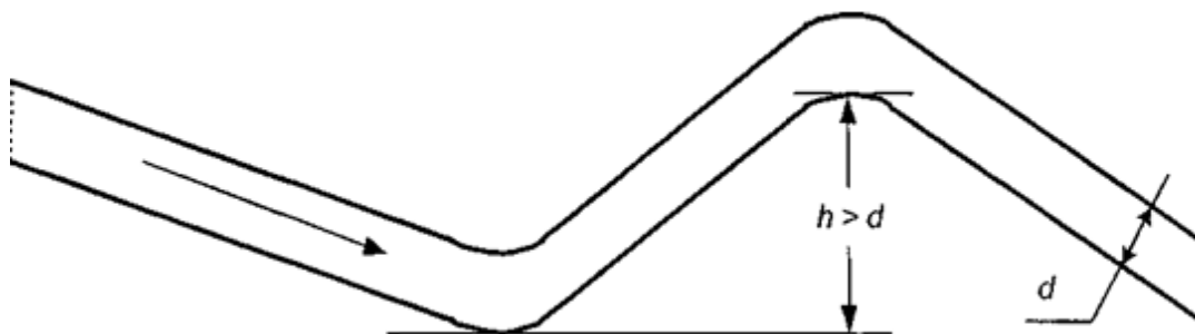
Рисунок 2.5 - Пример профиля трубопровода
