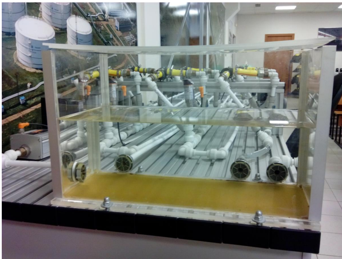
Рисунок 5.6 - Экспериментальный стенд трубопровода с установленным оборудованием
