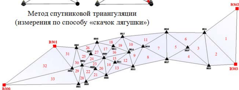
Схема выполнения ГНСС наблюдений сети первого класса
