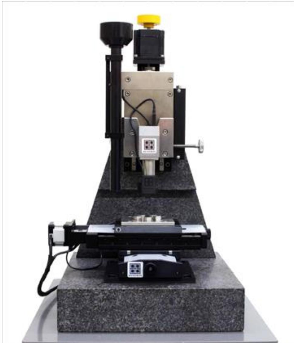
Рисунок 6 – пример конструкции твердомера по методу инструментального индентирования
