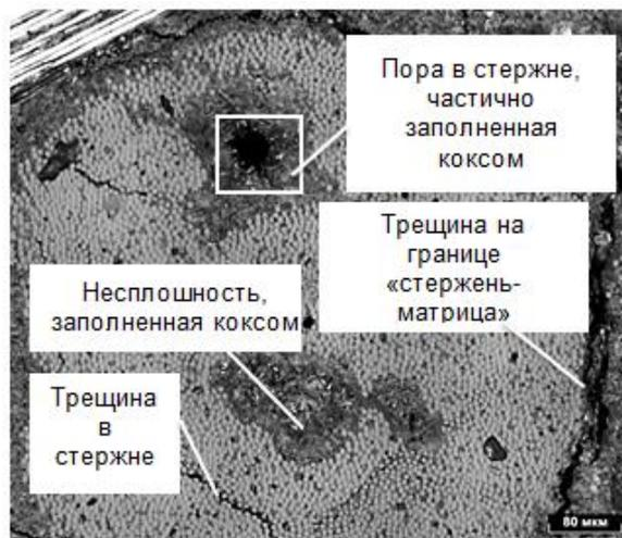
Рисунок 14 – Вид дефектов на поперечном шлифе стержня УУКМ (X200)
