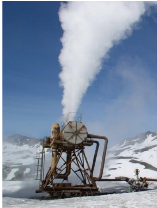
Рис 4.4. Полнообъемный сепаратор высокого давления.
