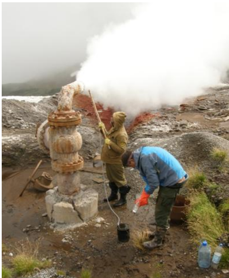
Рис 4.7 Отбор проб из фонтанирующей скважины № 019.
