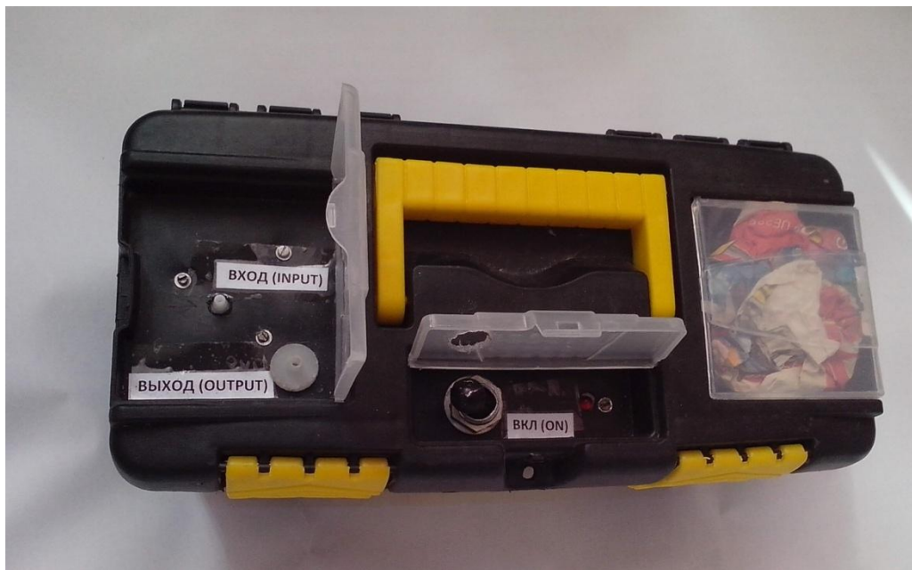
Рис 4.9 Пробоотборное устройство с автономным питанием.
