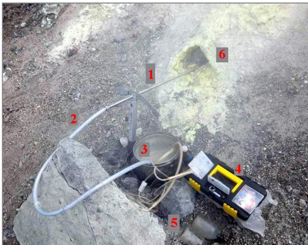
Рис 4.10 Пробоотборная система, в сборе при работе в кратере Авачинского вулкана.
