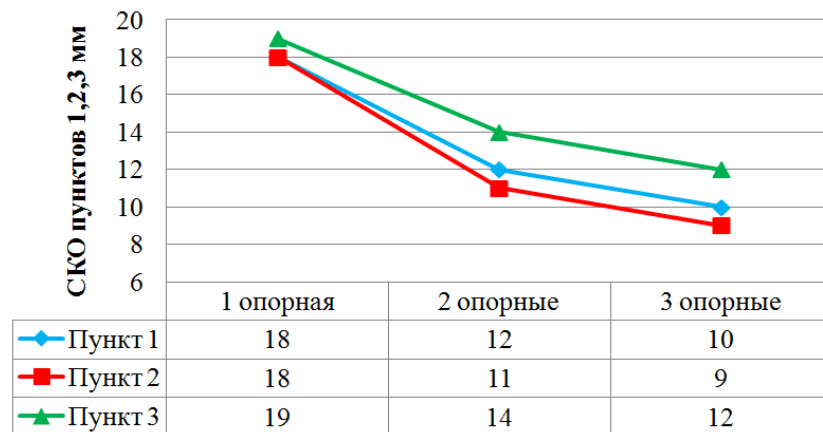
Рисунок 2.5 – График изменчивости СКО координат сетей, опирающихся на один, два и три исходных пункта
