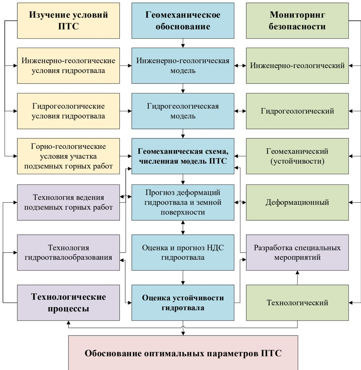
Рисунок 4.1 – Система геомеханического обеспечения устойчивости гидроотвалов на подрабатываемых территориях
