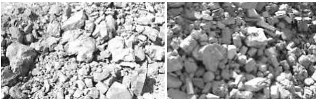
Рисунок 1.1 – Вид дробленых отходов боковой карбидокремниевой футеровки алюминиевых электролизеров, пропитанной фторсолями
