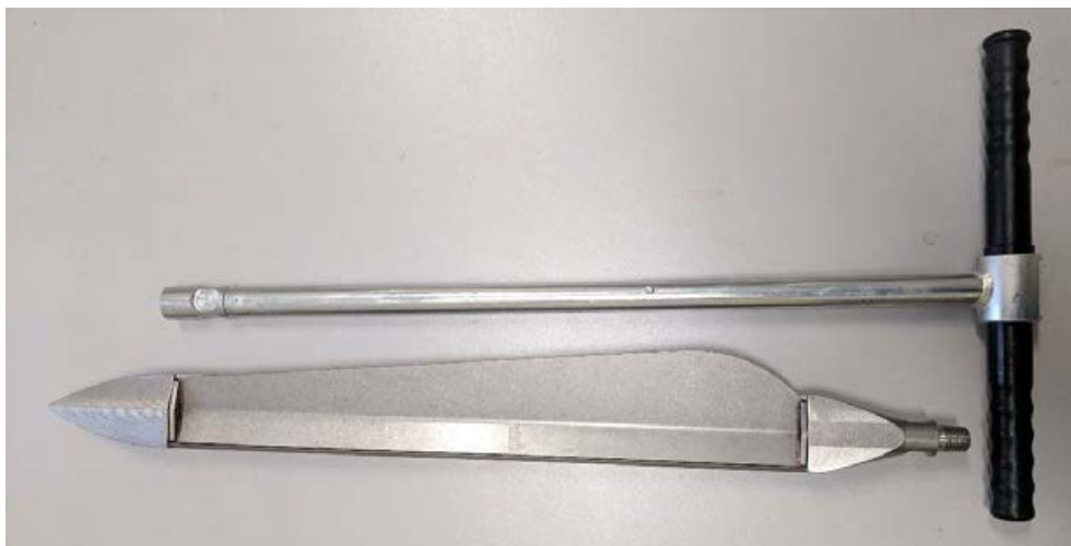
Рисунок 2.8 – Пробоотборное устройство с продольной щелью и поворотным устройством
