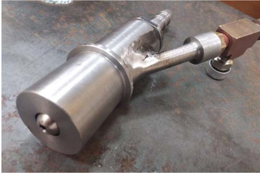
Рисунок 3.5 – Двухфазная пневматическая форсунка с внешним смешиванием
