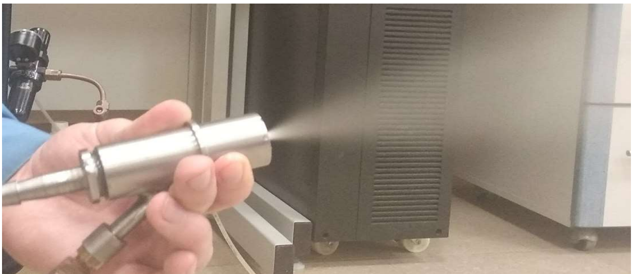
Рисунок 3.10 – Факел распыла суспензии при опробовании форсунки
