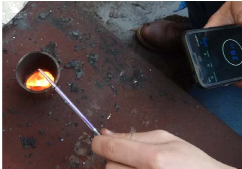
Рисунок 3.13 – Определение содержания загрязняющих веществ в отходящих газах
