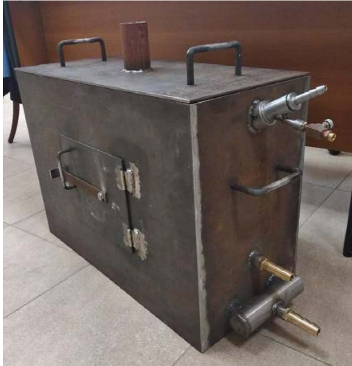
Рисунок 3.4 – Экспериментальный стенд для факельного сжигания жидких топлив
