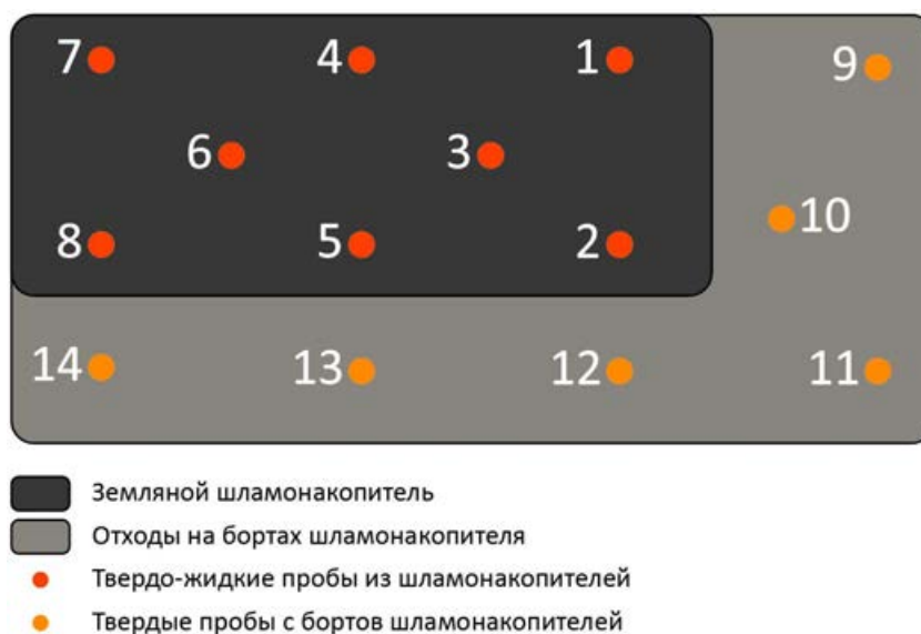
Рисунок 2.5 – Схема отбора проб отходов
