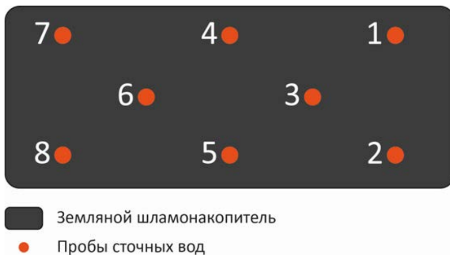
Рисунок 2.2 – Схема отбора проб сточных вод из земляного шламонакопителя
