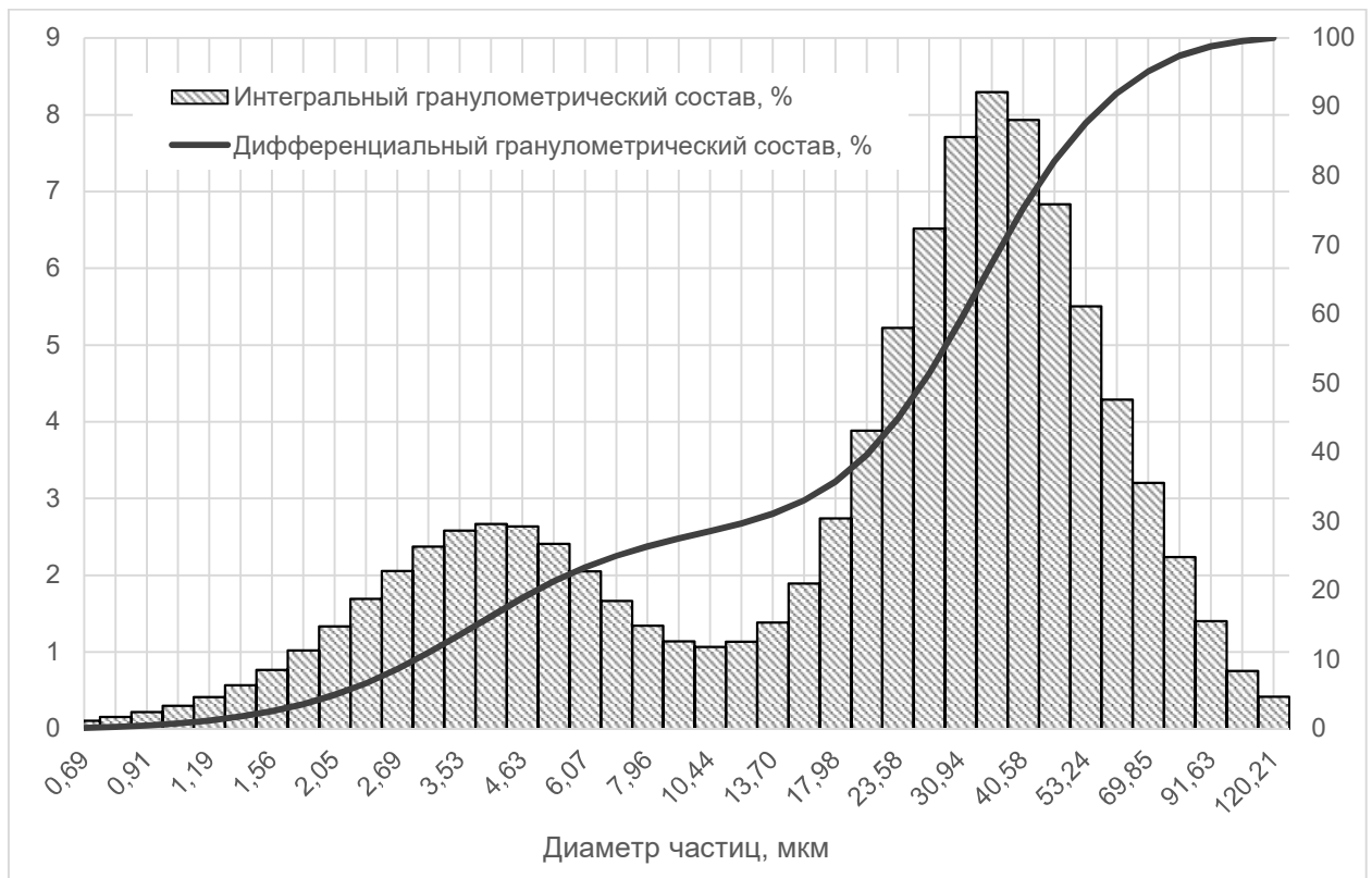
Рисунок 3.9 – Гранулометрический состав твердой части топливных суспензий
