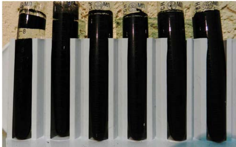
Рисунок 3.7 – Определение седиментационной стабильности образцов водоугольных суспензий
