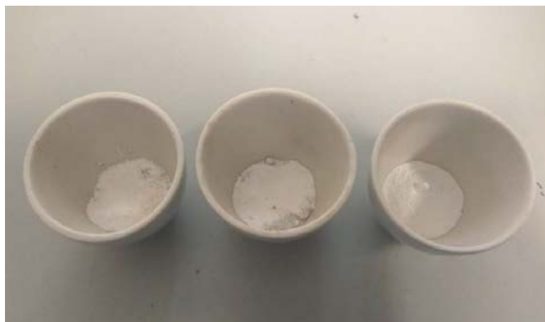
Рисунок 2.15 – Спекание проб для определения содержания мышьяка и сурьмы
