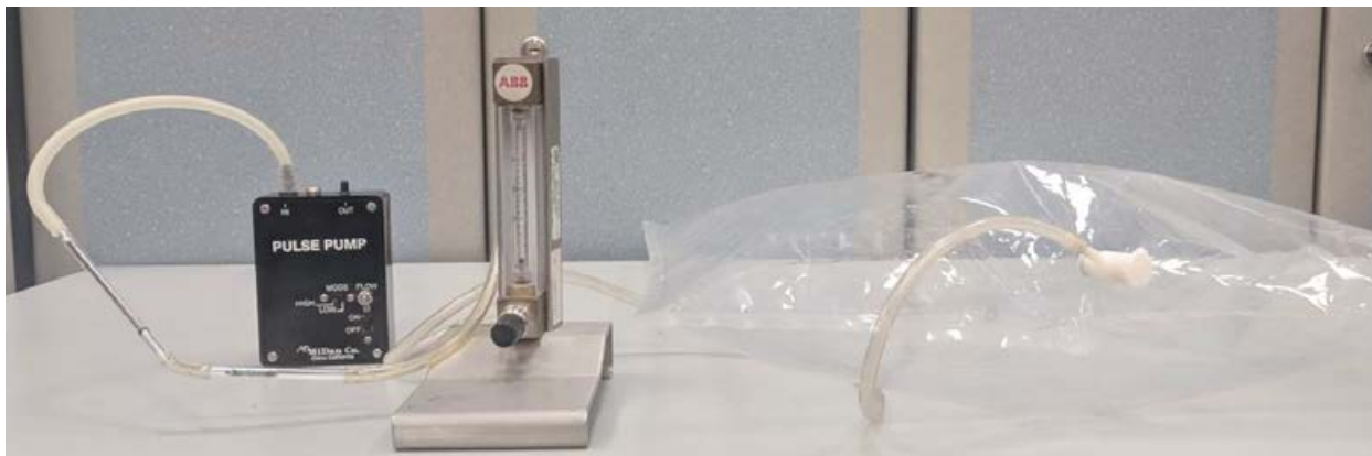
Рисунок 2.25 – Определение содержания оксидов серы в отходящих газах
