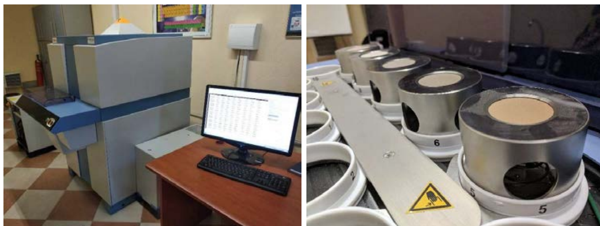
Рисунок 2.13 – Рентгенофлуоресцентный спектрометр Thermo Scientific™ ARL™ 9900 X-Ray WorkStation
