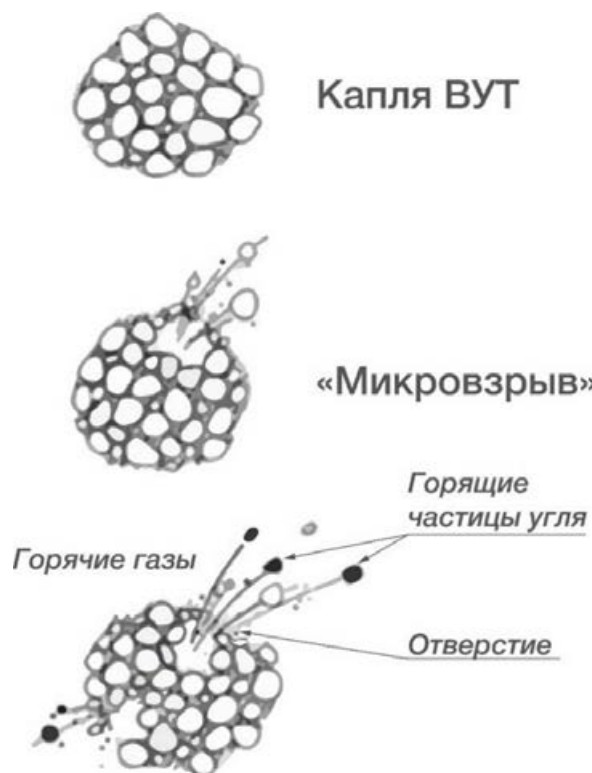
Рисунок 1.8 – Образование «микровзрывов» при нагревании капли водоугольного топлива [75]
