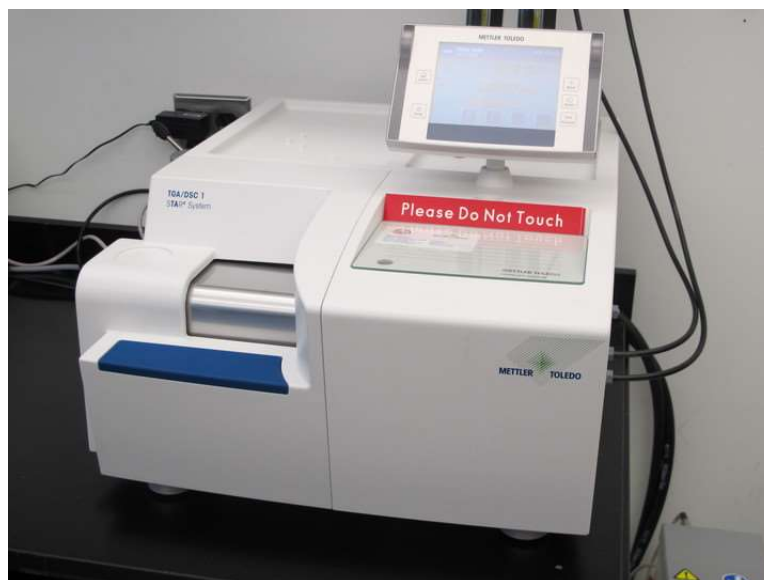
Рисунок 2.16 – Синхронный термоанализатор Mettler Toledo TGA/DSC 1
