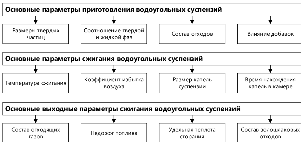
Рисунок 3.3 – Основные параметры термической утилизации отходов углеобогащения
