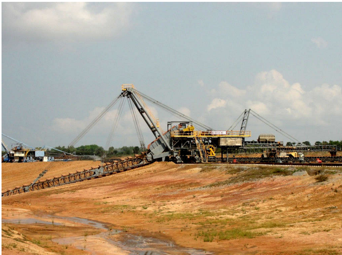
Рисунок 4.1 - Технологическая схема ведения горных работ с применением на добыче цепного экскаватора BEL 30 в карьере Кьенлыонг - Кьенганг цементно-шиферного комбината
