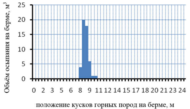
Рисунок 4.35 - Результаты анализа вероятности траектории падения горных пород кусков различных размеров по борту карьера с использованием программного обеспечения rocfall.
