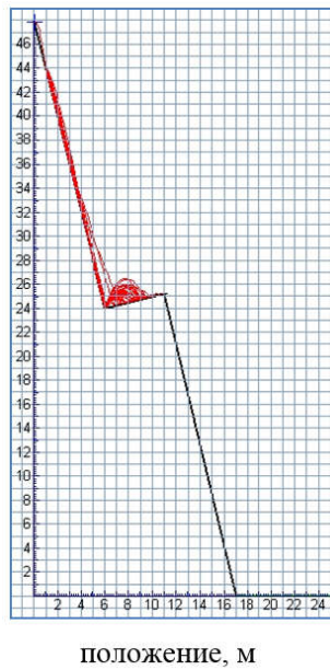
Рисунок 4.29 - Результаты анализа вероятности траектории падения горных пород кусков различных размеров по борту карьера с использованием программного обеспечения rocfall.
