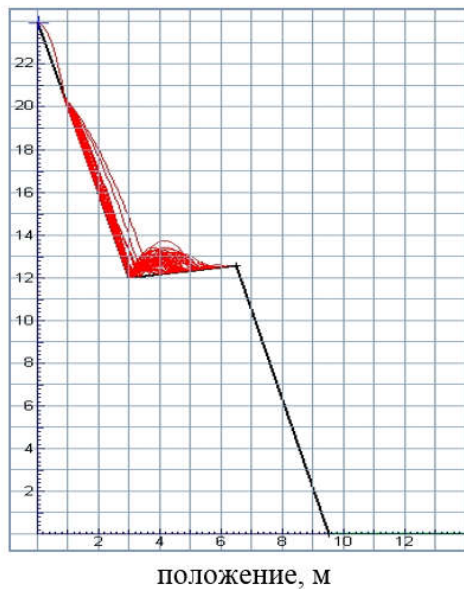
Рисунок 4.16 - Результаты анализа вероятности траектории падения горных пород кусков различных размеров по борту карьера с использованием программного обеспечения gosfall.
