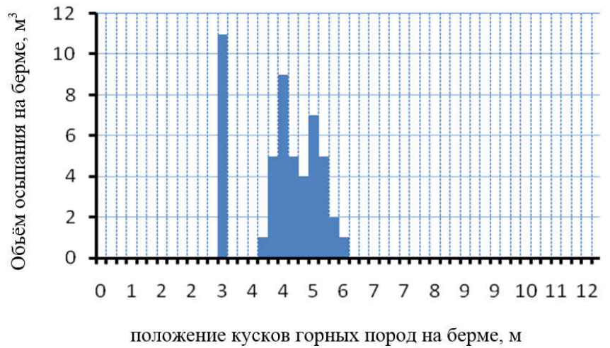
Рисунок 4.17 - Результаты анализа вероятности траектории падения горных пород кусков различных размеров по борту карьера с использованием программного обеспечения rocfall.
