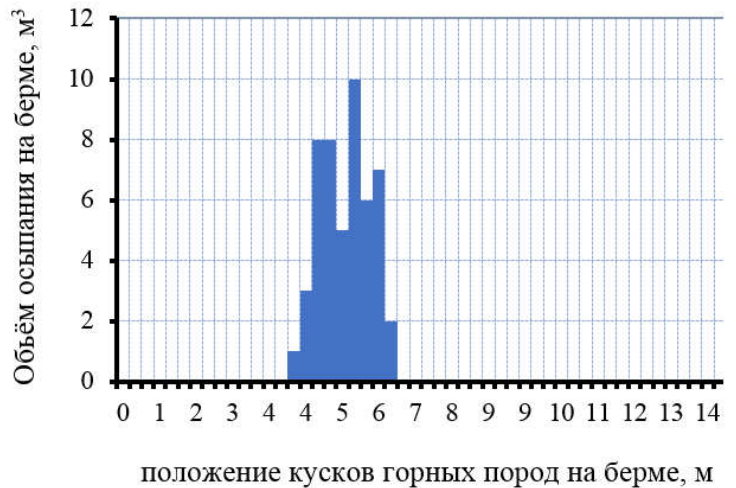
Рисунок 4.16 - Результаты анализа вероятности траектории падения горных пород кусков различных размеров по борту карьера с использованием программного обеспечения gosfall.
