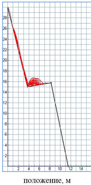
Рисунок 4.19 - Результаты анализа вероятности траектории падения горных пород кусков различных размеров по борту карьера с использованием программного обеспечения rocfall.
