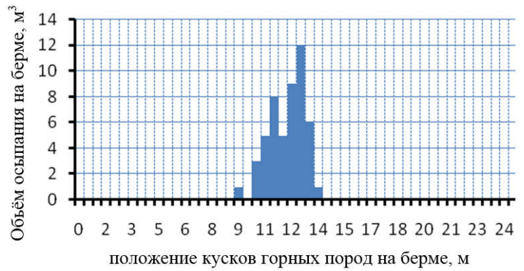
Рисунок 4.33 - Результаты анализа вероятности траектории падения горных пород кусков различных размеров по борту карьера с использованием программного обеспечения gsfall.
