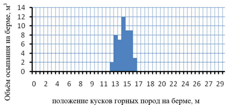
Рисунок 4.36 - Результаты анализа вероятности траектории падения горных пород кусков различных размеров по борту карьера с использованием программного обеспечения rocfall.
