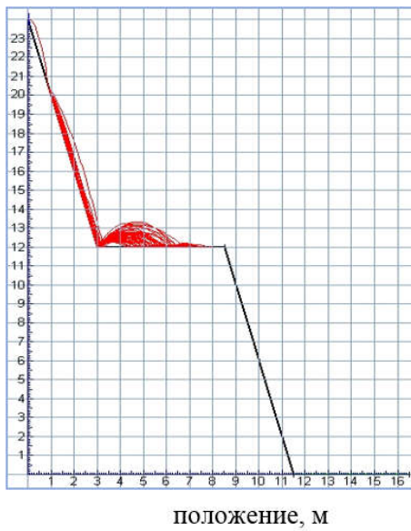
Рисунок 4.15 - Результаты анализа вероятности траектории падения горных пород кусков различных размеров по борту карьера с использованием программного обеспечения gosfall.
