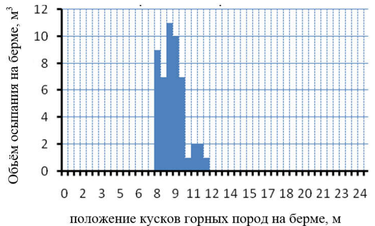
Рисунок 4.28 - Результаты анализа вероятности траектории падения горных пород кусков различных размеров по борту карьера с использованием программного обеспечения gosfall.
