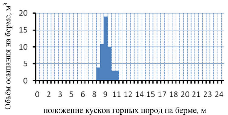
Рисунок 4.34 - Результаты анализа вероятности траектории падения горных пород кусков различных размеров по борту карьера с использованием программного обеспечения gsfall.
