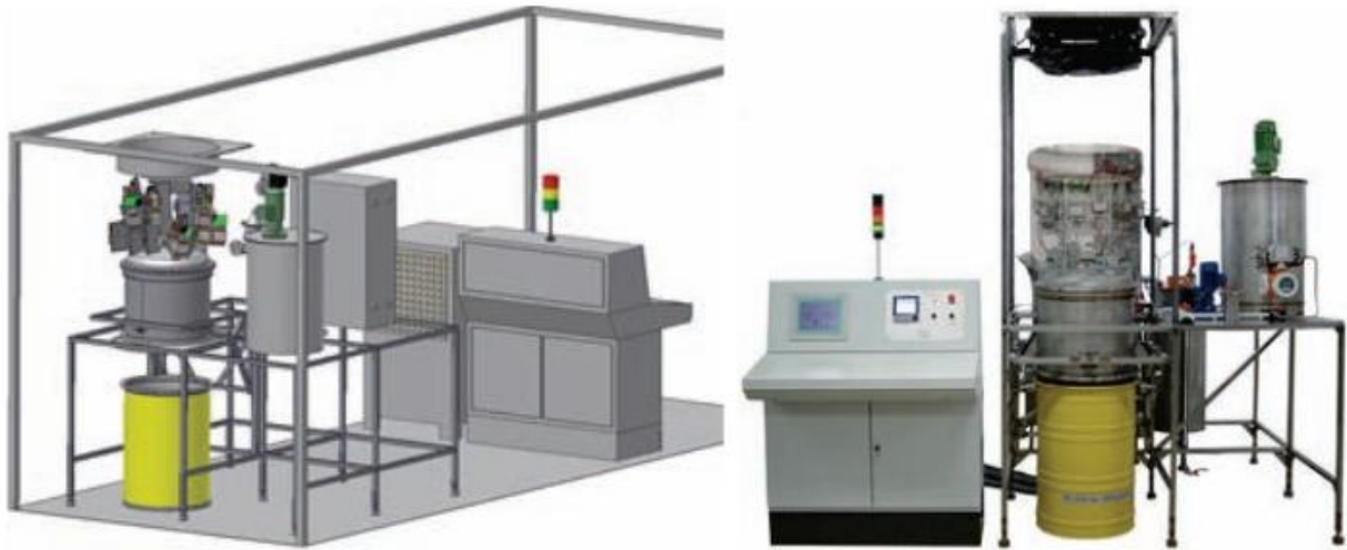
Рисунок 4.6 - СВЧ-установка серии MIDD [130]
