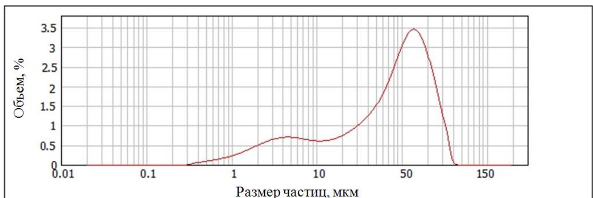
Рисунок 4.16 – Результаты исследования гранулометрического состава образцов углеродистых концентратов до СВЧ-обработки
