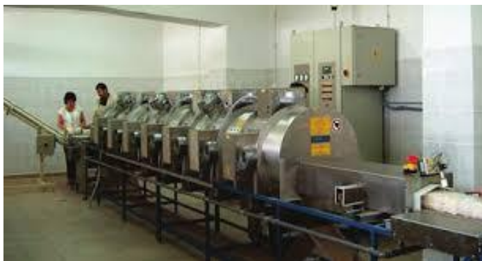
Рисунок 4.4 - СВЧ-установка серии MDBT (установленная СВЧ-мощность 21 кВт, производительность 300 кг/ч) [132]
