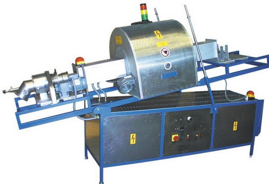
Рисунок 4.8 - СВЧ-установка серии MDRT [134]
