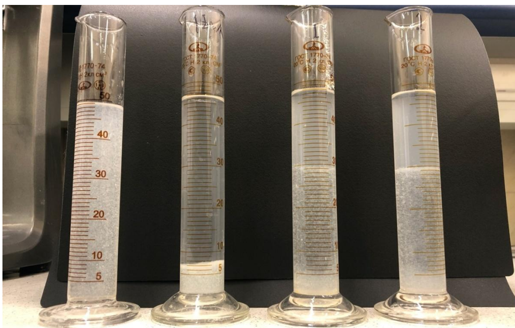
Рисунок 3.8 – Результаты исследования совместимости полимерного состава «SPMI-7» концентрацией 1,25% с растворами: 1 – в дистиллированной воде; 2 – в растворе NaCl концентрацией 18 г/л; 3 – в пластовой воде состава 1; 4 – в пластовой воде состава 2.
