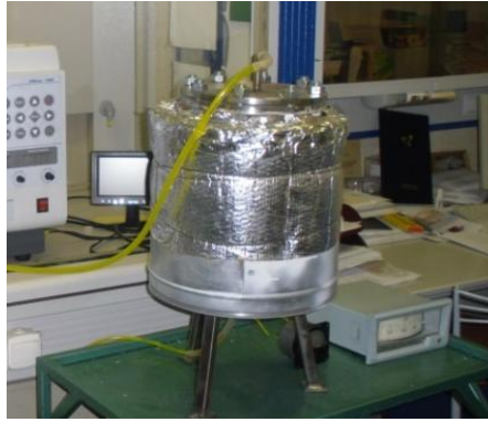
Рисунок 2.2 – Реактор для синтеза укрупненных партий металлических продуктов
