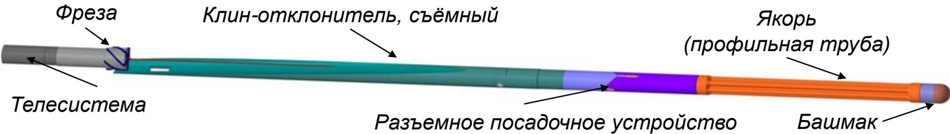
**Клин-отклонитель для зарезки бокового ствола за два спуска**
