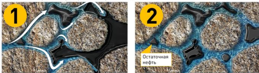
Состояние порового пространства при закачке воды
