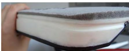
Рис. 4. Материал „мольто”, который покрывает верхний слой корпуса
