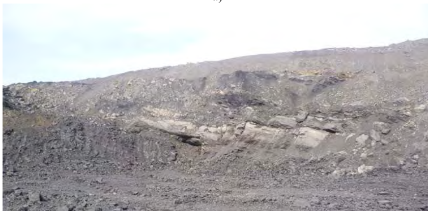
Рис. 2. Обнаружение границ слоев пород с разными свойствами: а) радарограмма, б) фото после вскрытия уступа
