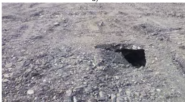
Рис. 3. Подземная горная выработка: а) обнаружение на радарограмме, б) фото после зачистки бульдозером
