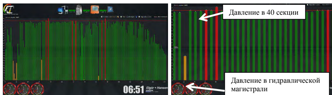
Рис. 2. Окно приложения EH-PressCaterClient. Графики давления в стойках механизированной крепи
