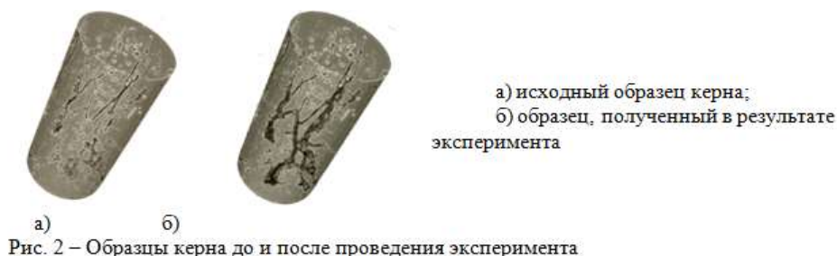
Рис. 2 – Образцы ядра до и после проведения эксперимента
