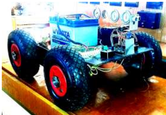
Рис. 2 Колесный электромобильный мехатронный комплекс с системой бортового поворота
