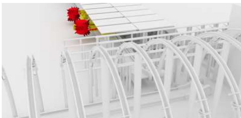
Рис.2 – Модель сопряжения лавы со штреком пласта h 7
