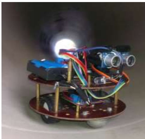
Рис. 3 Внешний вид шасси мехатронного комплекса для диагностирования подземной выработки круглого сечения
