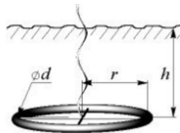
Задавшись параметрами  $h$  и  $d$ , указанными в таблице, а также приняв  $G = 0,03 \frac{1}{\text{Ом} \cdot \text{м}}$ , найдите радиус  $r$ , обеспечивающий требуемое сопротивление заземления  $R = 15 \text{ Ом}$ .
