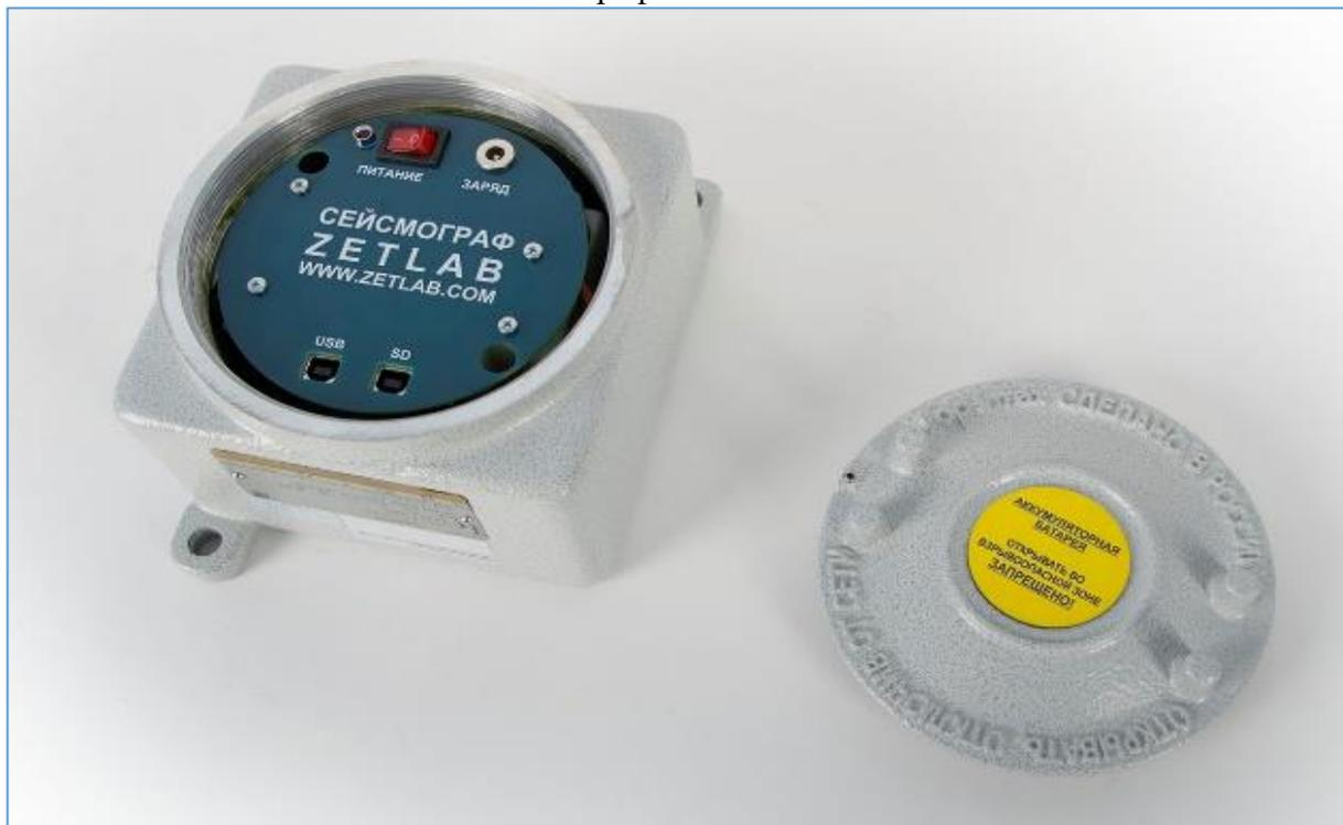
Рисунок 2.1 – Общий вид используемого сейсмооборудования
