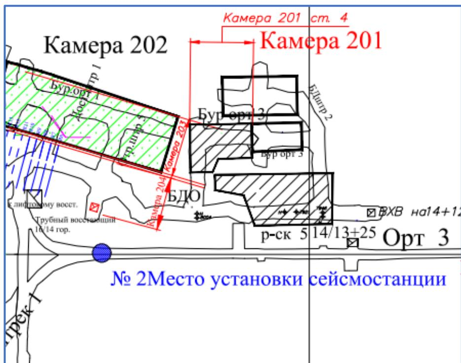
Рисунок 2.7 – Фрагмент плана горизонта 14, на котором проводились натурные исследования. зеленой штриховкой указано место проведения массовых взрывов
