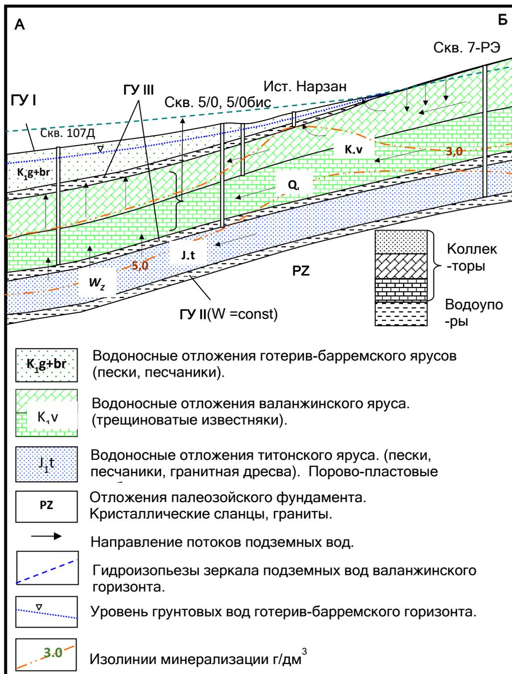
Рис. 14. Геолого-гидрогеологический разрез Кисловодского месторождения минеральных вод
