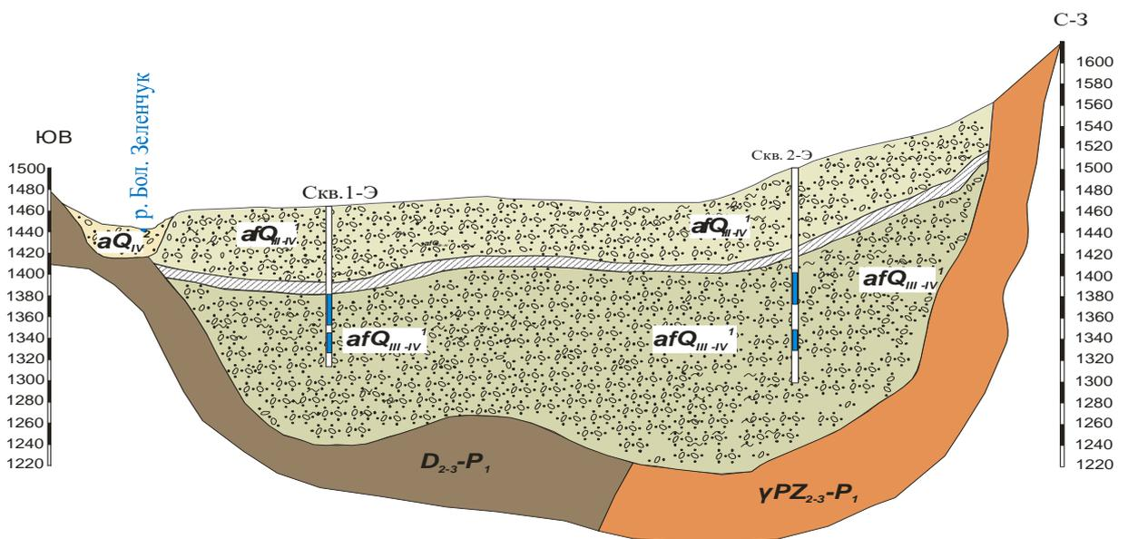
Рис. 11. Геологический разрез по Архызскому месторождению подземных вод.
