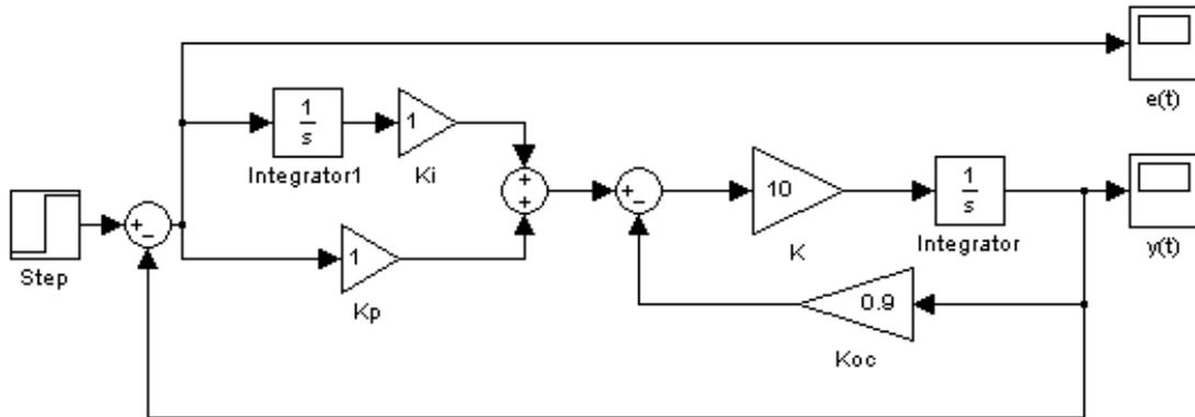
Рис. 4.2 Модель системы с ПИ - регулятором
