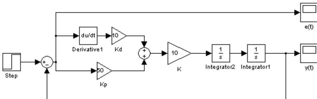
Рис. 4.3 Модель системы с ПД - регулятором
