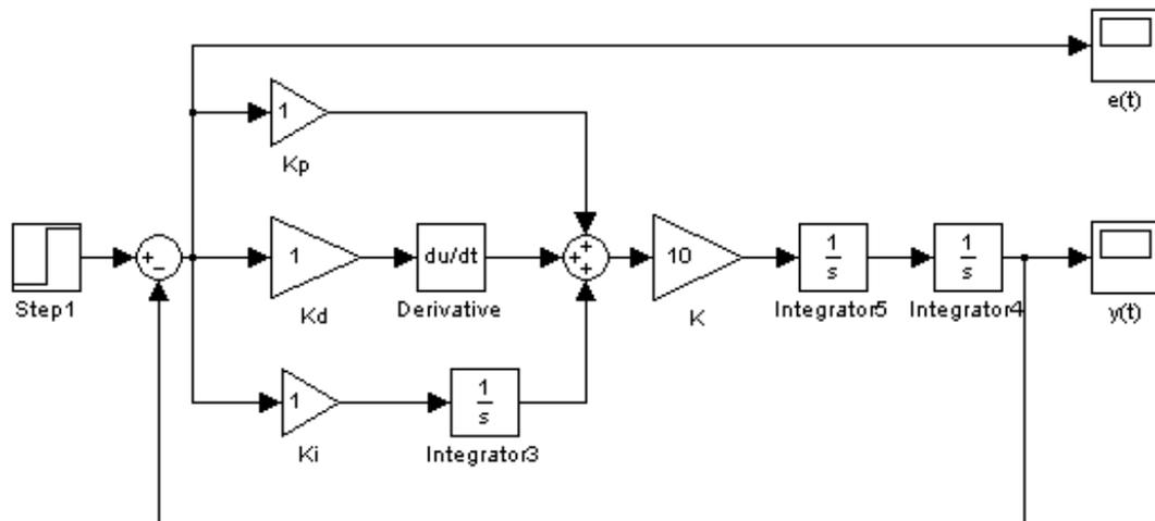
Рис. 4.4 Модель системы с ПИД - регулятором
