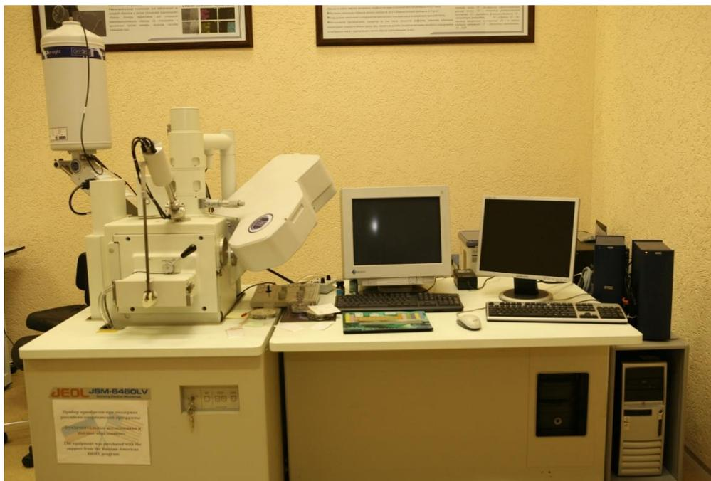
Растровый электронный микроскоп JSM-6460LV предназначен для получения изображения поверхности образца. Области применения - минералогия, геология, палеонтология, металлургия, разработка новых материалов.
