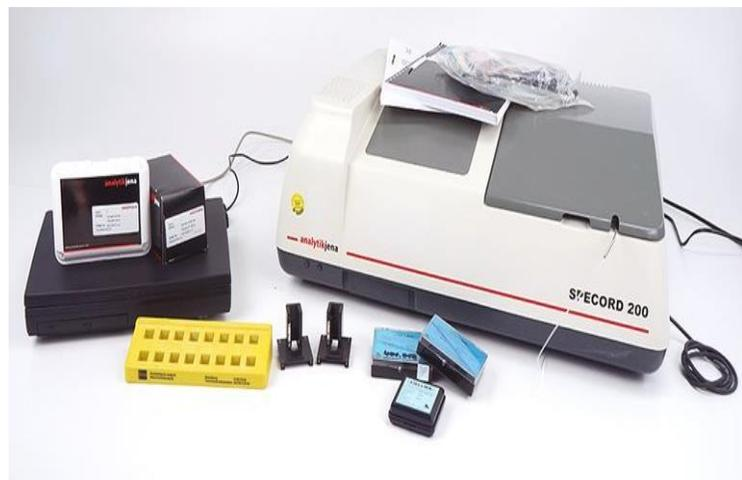
Спектрофотометр предназначен для регистрации электронных спектров поглощения оптически прозрачных сред (жидкостей, растворов, пленок в режиме пропускания и твердых массивных и дисперсных образцов – в режиме отражения). Области применения - минералогия, геммология, материаловедение.
