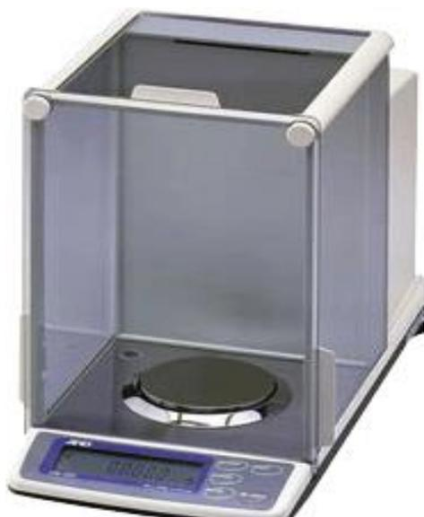
Принцип действия весов основан на измерении электрического сигнала, пропорционального усилию, создаваемому взвешиваемым объектом. Весы имеют систему калибровки нулевого равновесия и корректировки погрешности измерения, обусловленную изменением температуры окружающей среды. Весы выполнены из алюминиевого сплава и имеют противосквозняковый бокс.
