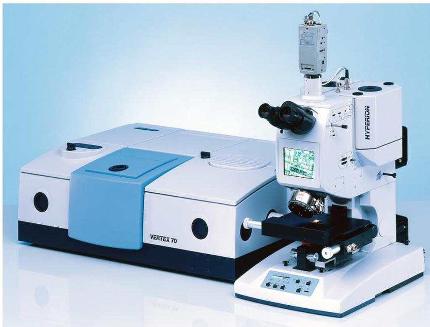
Инфракрасный спектрометр с микроскопом предназначен для регистрации инфракрасных спектров поглощения, пропускания или отражения. Области применения - минералогия, геммология, материаловедение, разработка новых материалов.
