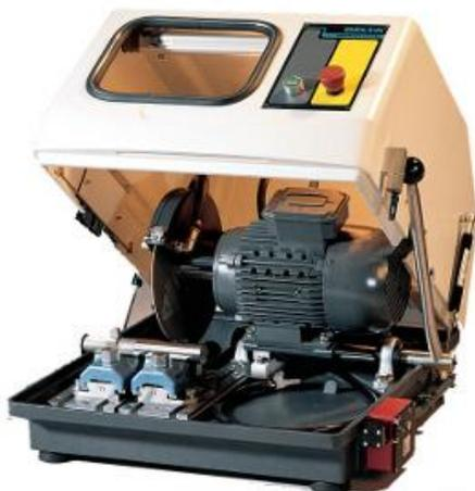
Линейная автоматическая прецизионная пила предназначена для резки черных и цветных металлов, керамики, металлических матриц композитного материала, термически нанесенных покрытий, полимеров, угля, стекла, минералов.
