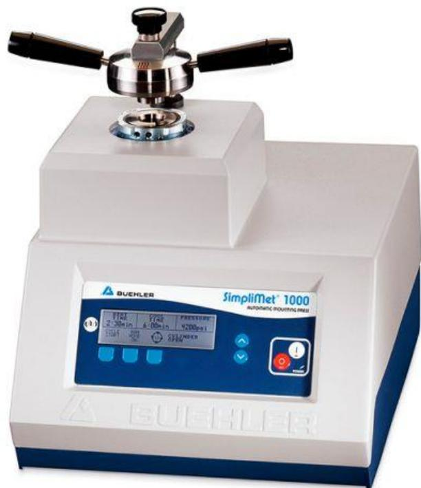
Автоматический электрогидравлический пресс применяется для запрессовки твердых образцов горных пород, руд, металлургических и экологических проб в термоактивные смолы и изготовления шайб определенного диаметра. Позволяет подготавливать и в дальнейшем исследовать мелкие образцы и образцы неправильной формы.
