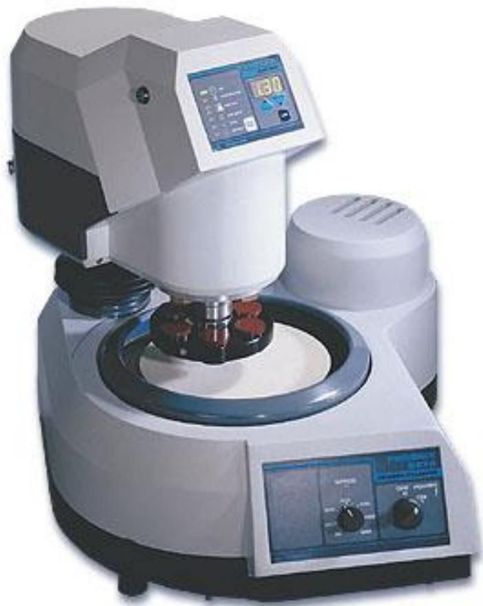
Механическая подготовка поверхности с целью последующего исследования её микроструктуры методами оптической и электронной микроскопии. Создание совершенно плоского и хорошо отполированного образца минерала или горной породы, с неровностями на поверхности пренебрежимо малыми по сравнению с глубиной проникновения электронов, составляющей в среднем 2-3 мкм. Процесс полирования необходим для полного исключения повреждений поверхности и является финальным в процессе пробоподготовки.
