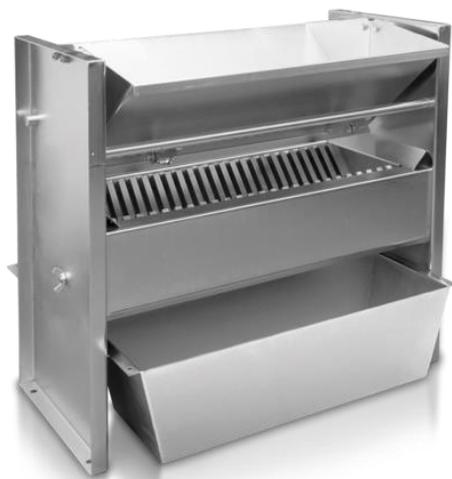
Предназначен для пробоотбора и деления проб сыпучих материалов.
