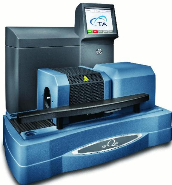
Термоанализатор SDT Q600 представляет собой совмещенный ТГА/ДТА/ДСК анализатор, который позволяет одновременно использовать три метода термического анализа – термогравиметрию, дифференциальный термический анализ и дифференциальную сканирующую калориметрию. Области применения - минералогия, металлургия, разработка новых материалов.
