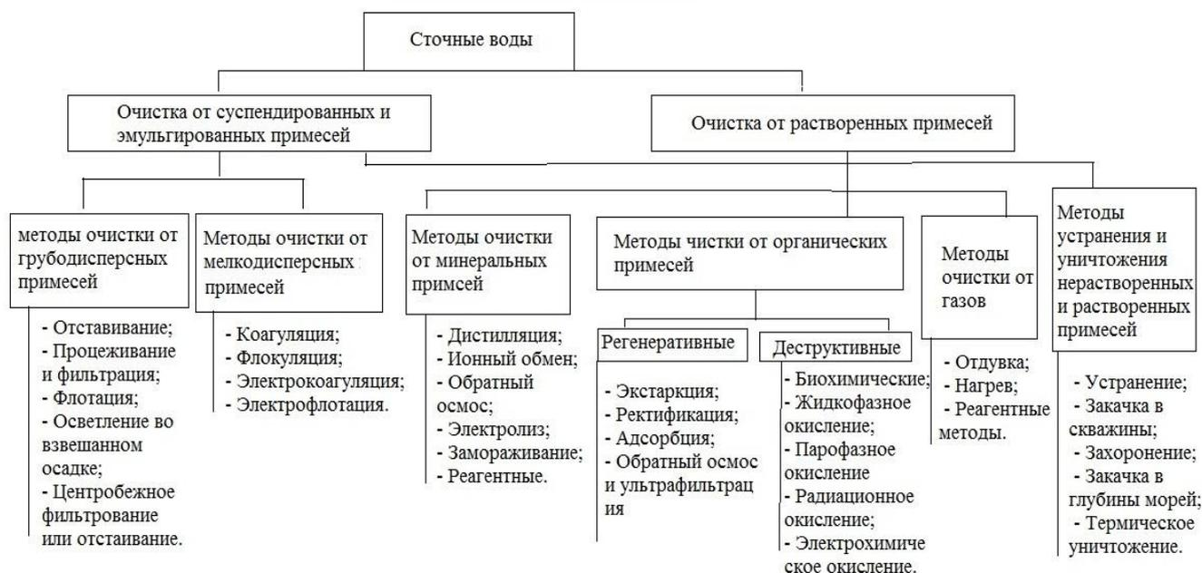
Рисунок 1 – Классификация методов очистки сточных вод
