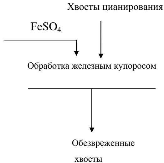
Рисунок 11 - Технологическая схема процесса обезвреживания цианидсодержащих сточных вод с использованием железного купороса
