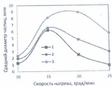
Рис. 9. Зависимость среднего диаметра оксида алюминия от температуры прокаливания и скорости нагрева проб гиббсита: 1 – 1200 градусов, 2 – 1250 градусов, 3 – 1300 градусов.
