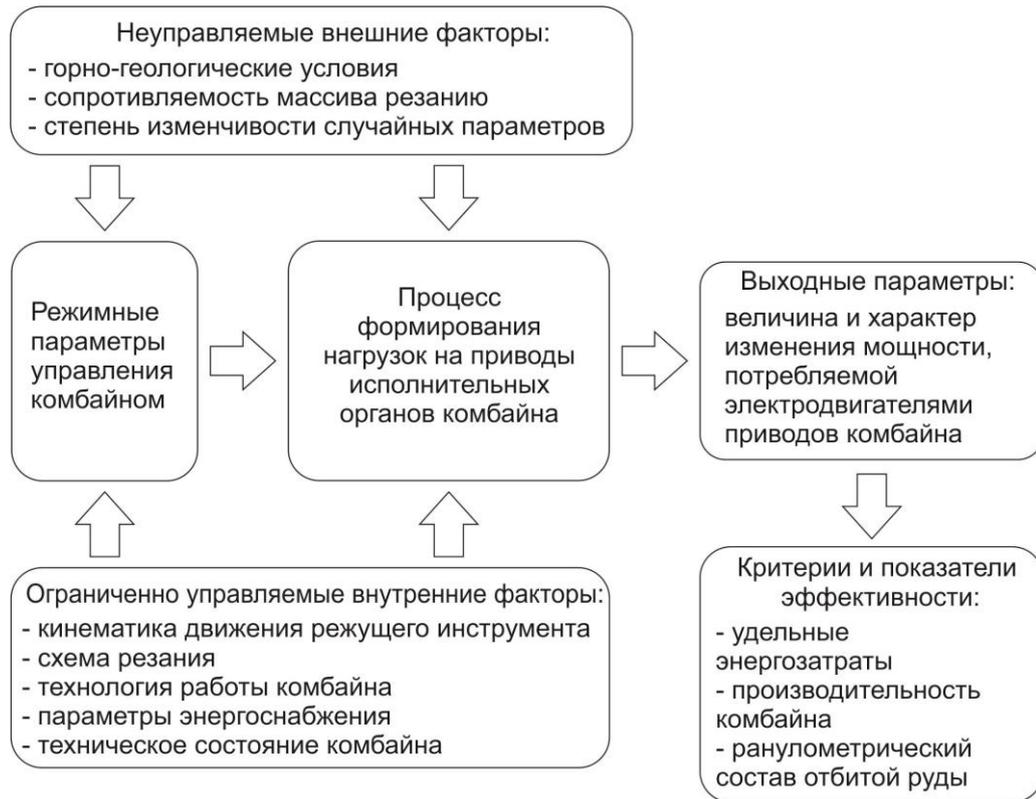
Рисунок 1.4 – Схема формирования нагрузок на приводы исполнительных органов при работе проходческо-очистного комбайна
