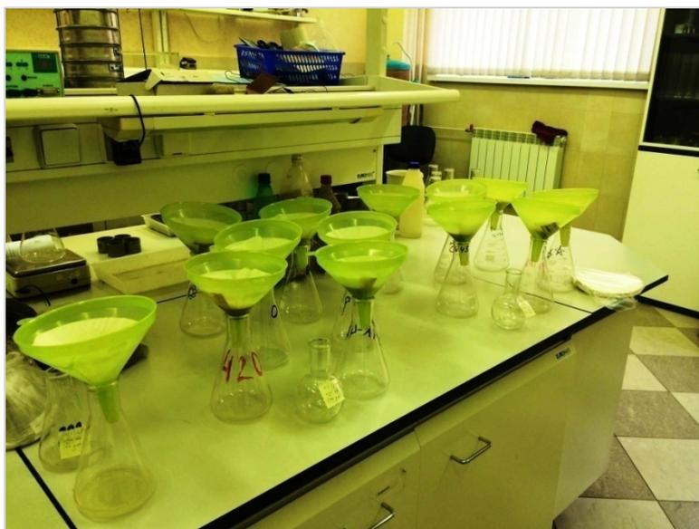
Рисунок 2.22 – Приготовление водных вытяжек для химического анализа их состава
