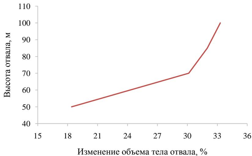
Рисунок 3.27 – Зависимость изменения объема тела отвала от его высоты
