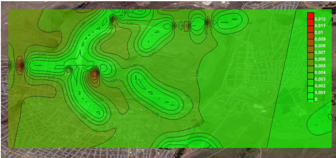
Рисунок Д.4 - Атмохимический ореол загрязнения сероводородом на высоте 100 м от дневной поверхности
