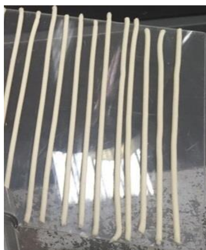
Рисунок 30 – Жгуты пептизированного гидроксида алюминия после пропускания через фторопластовую фильеру с d_{отв.} = 5 \text{ мм}
