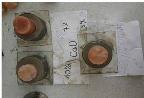
Рисунок 6 - Формирование контакта цилиндрических образцов соли с тампонажной смесью
