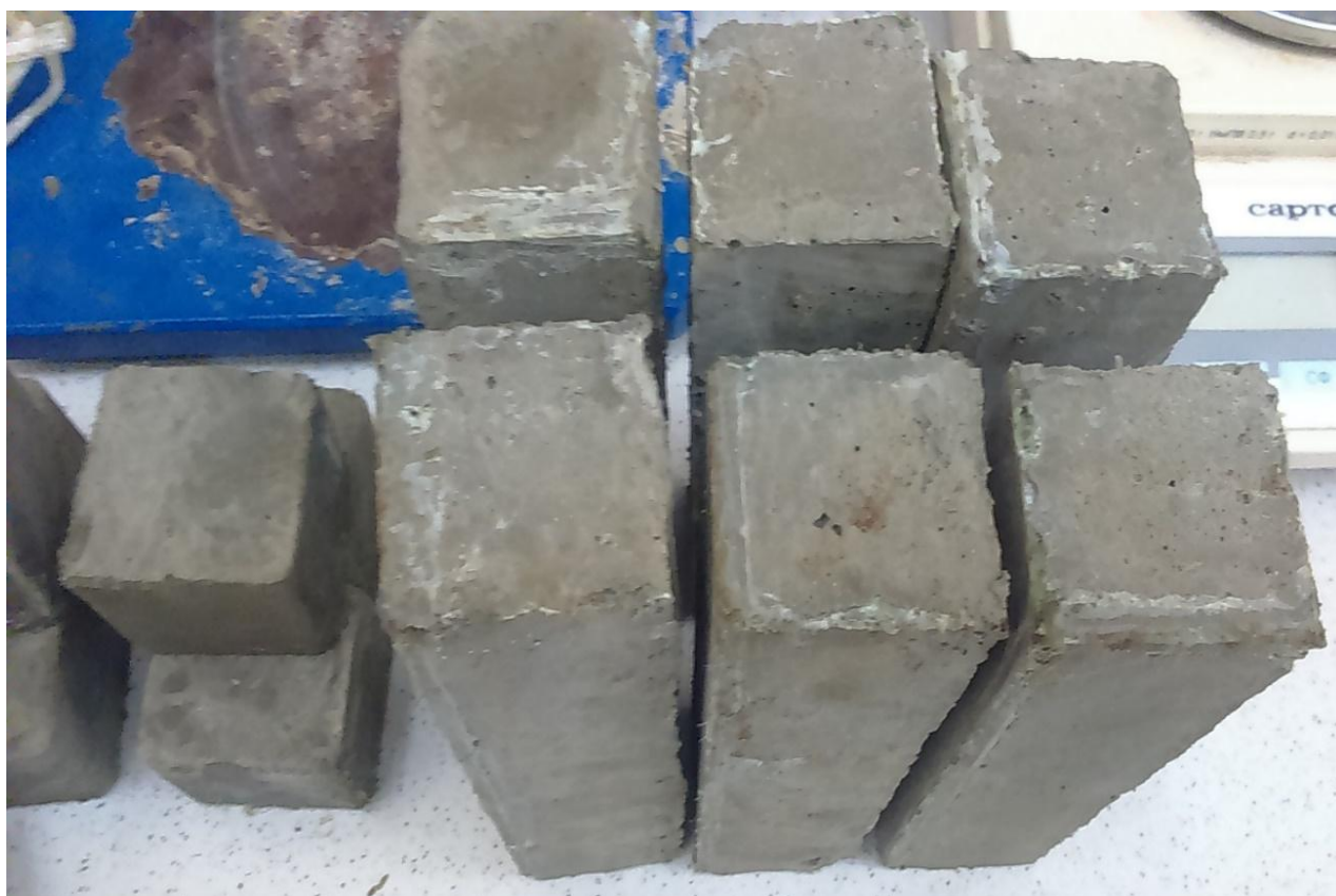
Рисунок 3.7 - Образцы цементного камня, извлеченные из резервуара с агрессивными средами для исследования прочности на сжатие и изгиб
