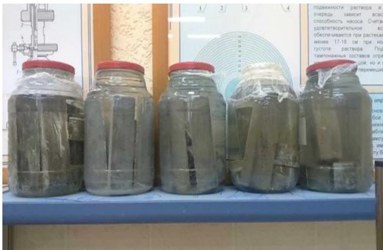
Рисунок 2.1 - Подготовка образцов и их хранение в агрессивных средах
