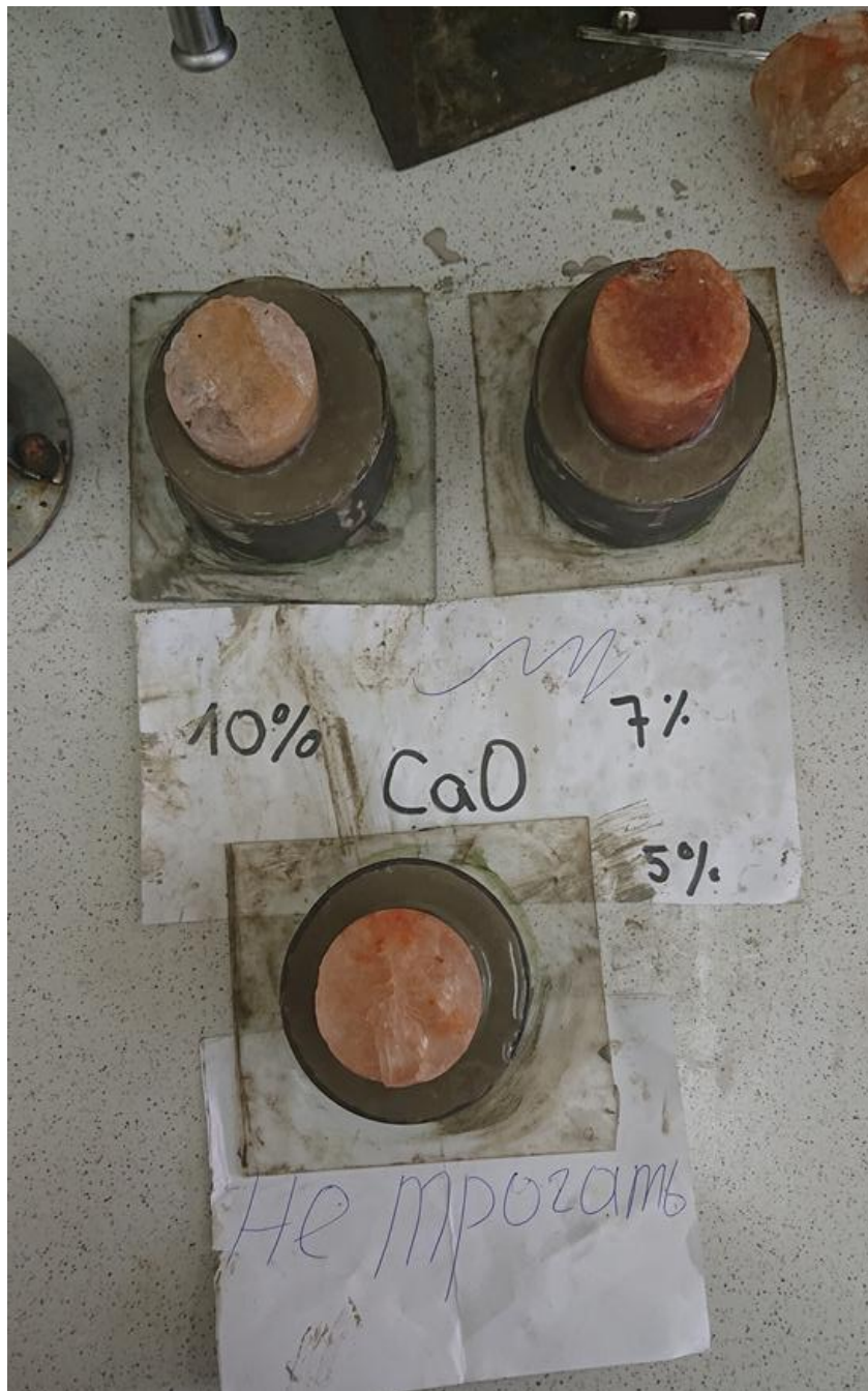
Рисунок 2.4 - Формирование контакта цилиндрических образцов соли с тампонажной смесью
