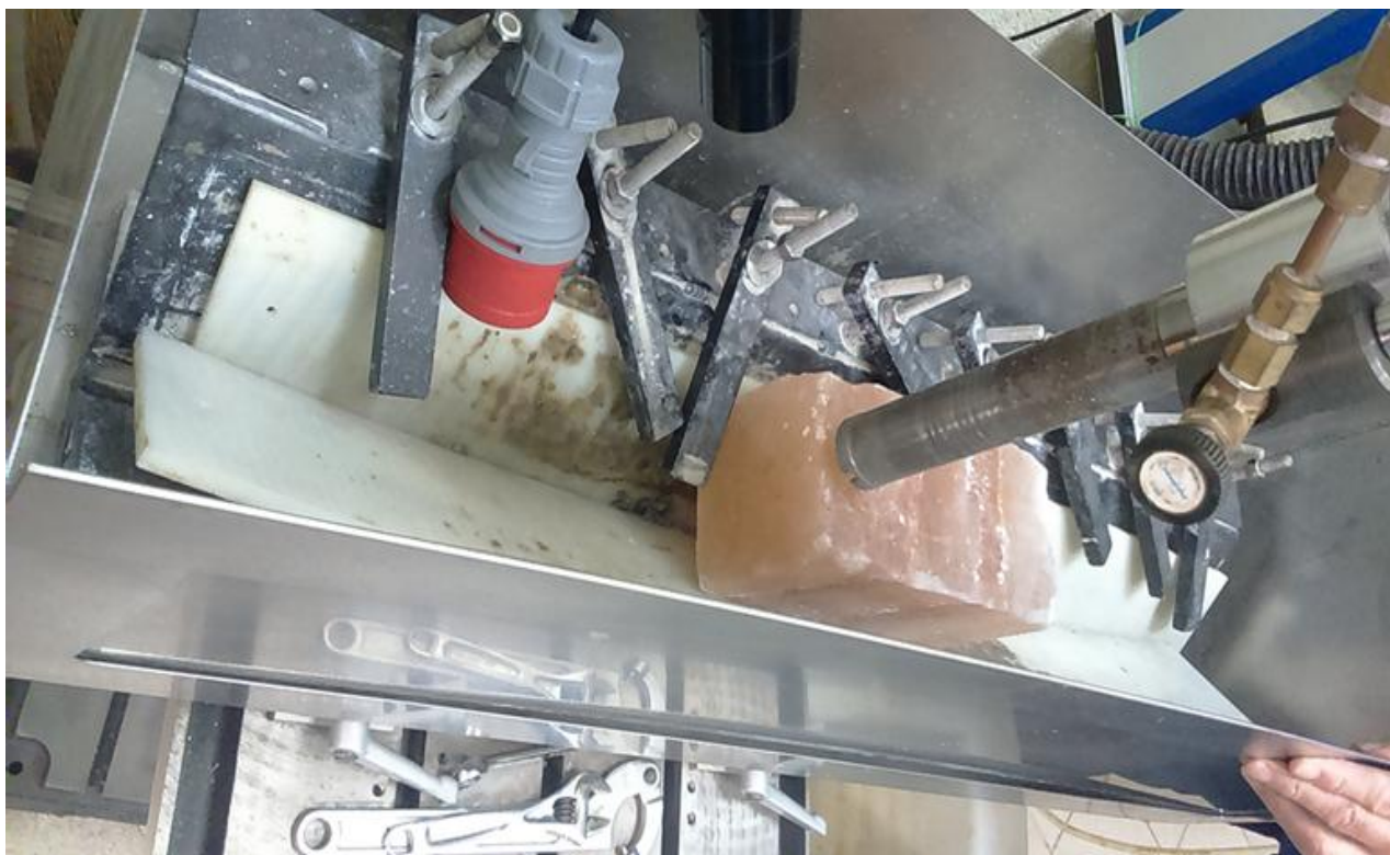
Рисунок 2.3 - Выбуривание образцов соли (NaCl) для исследования контактной прочности тампонажных составов
