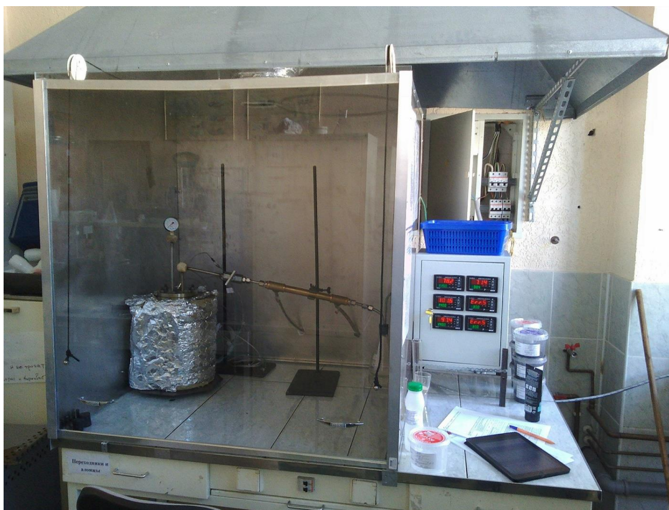
Рисунок 2.4 – Лабораторная установка замедленного коксования «УЗК-1» Санкт-Петербургского горного университета [18,19]
