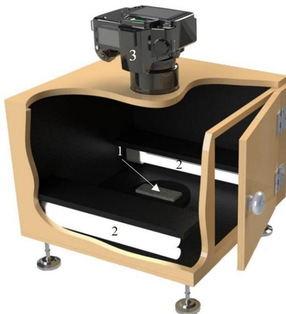
Рисунок 6 - Осветительная камера для фотографирования пластин минеральных материалов до нанесения битума, после нанесения битума и термостатирования и после испытания: 1 – пластина минерального материала, 2 – источники света, закрытые матовыми стеклами, 3 – цифровой фотоаппарат
