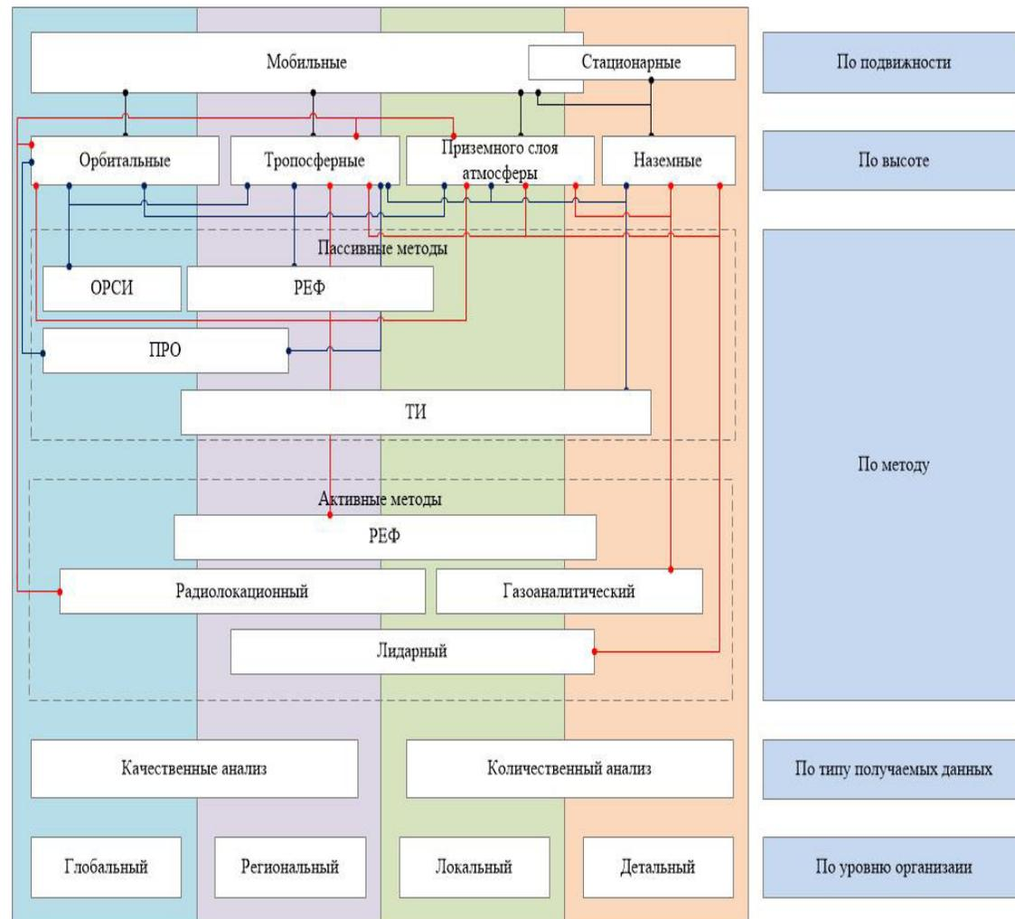
Рисунок 3 – Структура применимости дистанционных методов при экологическом мониторинге (где: ОРСИ – метод отраженного и рассеянного солнечного излучения, РЕФ – метод рефракции, ПРО – метод прозрачности атмосферы, ТИ – метод теплового излучения).
