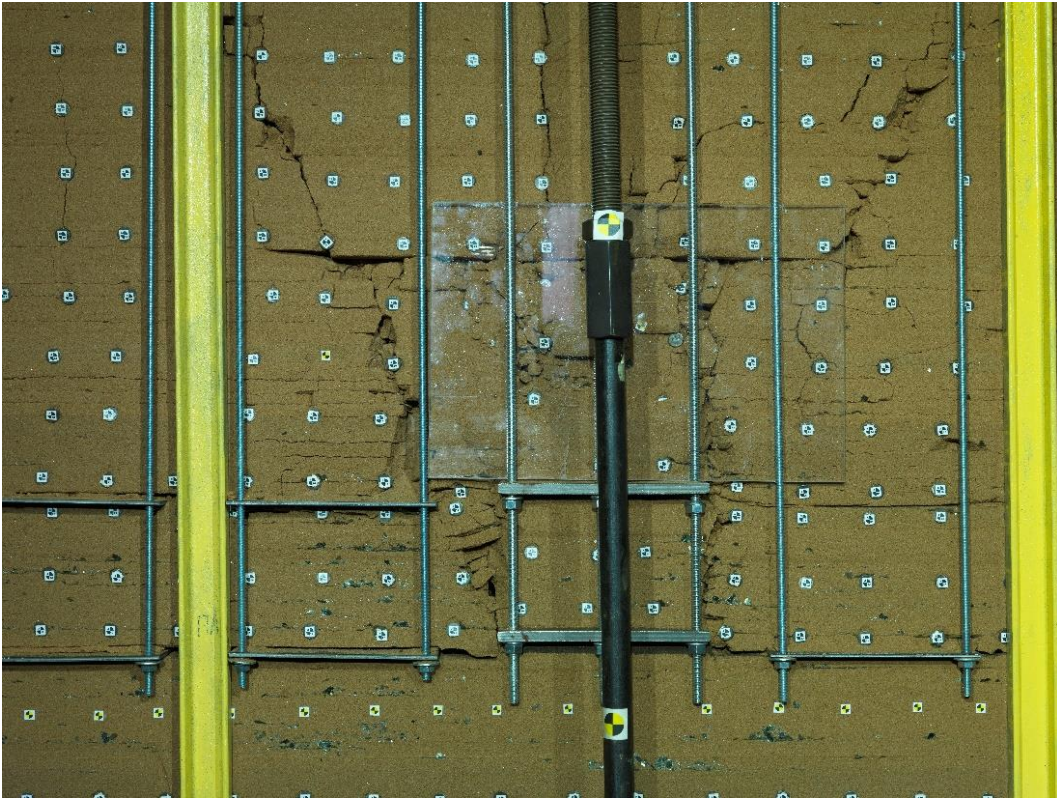
Рисунок 3.17 – Состояние пород кровли пласта над целиком и в выработанном пространстве при высоте целика, равной мощности пласта 51
