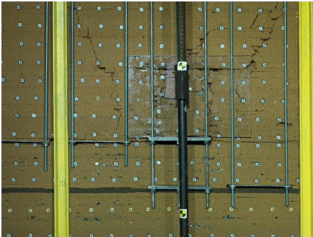
Рисунок 3.14 – Межучастковый целик, оставленный в выработанном пространстве пласта 52, после уменьшения его высоты на 50%
