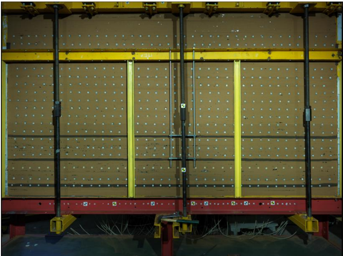
Рисунок 3.8 – Общий вид модели для исследования закономерности перераспределения напряжений в надрбатываемых пластах при искусственной разгрузке целиков от повышенного горного давления
