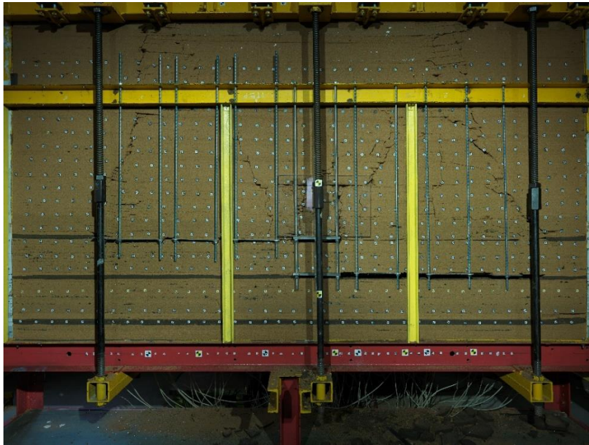
Рисунок 3.15 – Общий вид модели при отработке первого выемочного столба, расположенного по пласту 51 справа от формируемого целика
