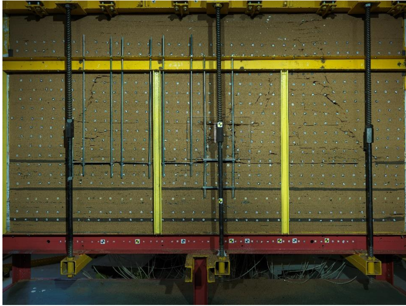
Рисунок 3.12 – Характер развития трещин в подработанном массиве при полной разгрузке целика, оставленного в выработанном пространстве пласта 52
