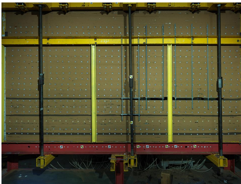
Рисунок 3.11 – Состояние модели при отработке первого выемочного столба, расположенном по пласту 52 справа от формируемого целика
