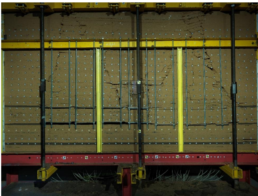
Рисунок 3.16 – Общий вид модели при отработке второго выемочного столба, расположенного по пласту 51 слева от формируемого целика
