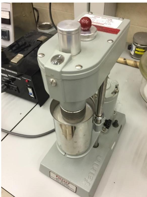
Рисунок 2.1 – Ротационный вискозиметр Fann 35SA
