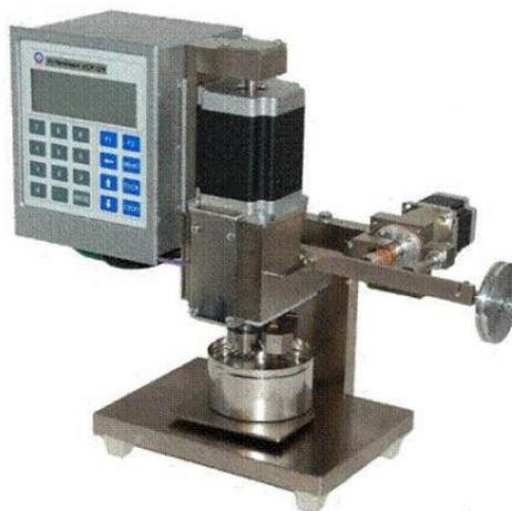
Рисунок 2.2 – Установка для определения смазочной способности бурового раствора УСП1-М
