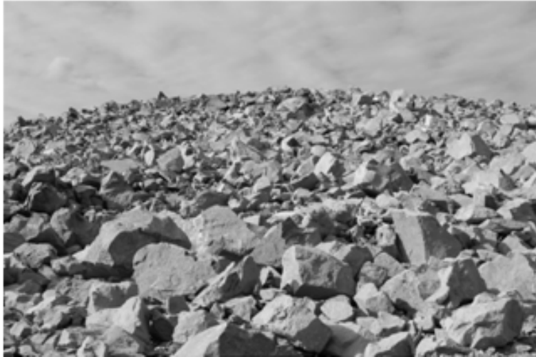
Рисунок 10 - Развал горной массы после взрыва и распределение грансостава (при применении сплошной конструкции заряда)
