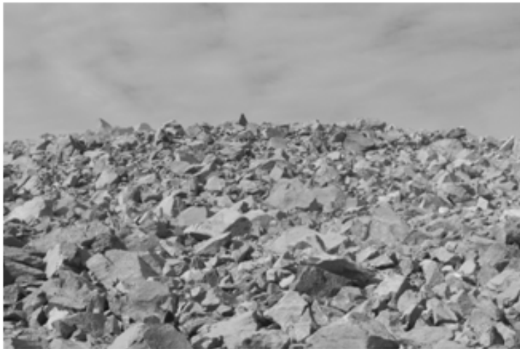
Рисунок 11 - Развал горной массы после взрыва и распределение грансостава (при применении комбинированной конструкции из разнотипных ВВ, разделенных профилированным инертным промежутокм)
