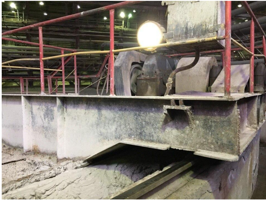
Рисунок 1.13 – Рама с приводом сгустителя П-30, эксплуатируемого на Кировском филиале АО "Апатит" ФосАгро
