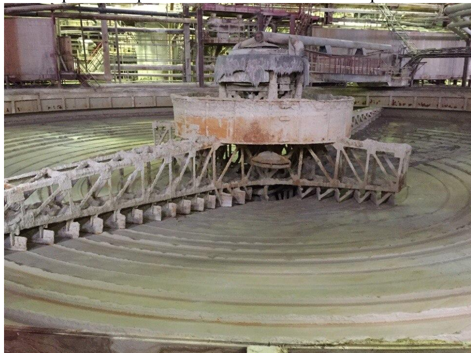
Рисунок 1.14 – Сгуститель П-30, эксплуатируемый на Кировском филиале АО "Апатит" ФосАгро
