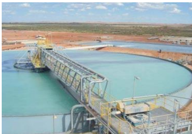
Рисунок 1.9 – Сгуститель серии GNJ фирмы DEKREE
