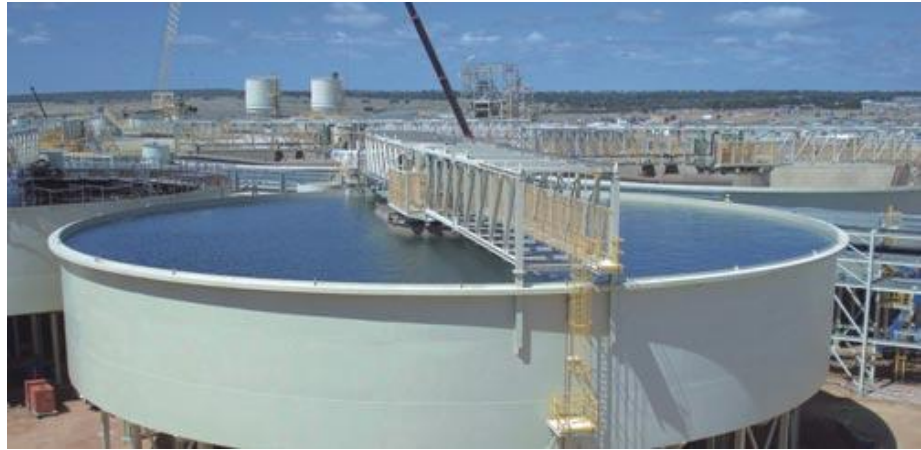
Рисунок 1.5 – Сгуститель серии GNZ фирмы DEKREE
