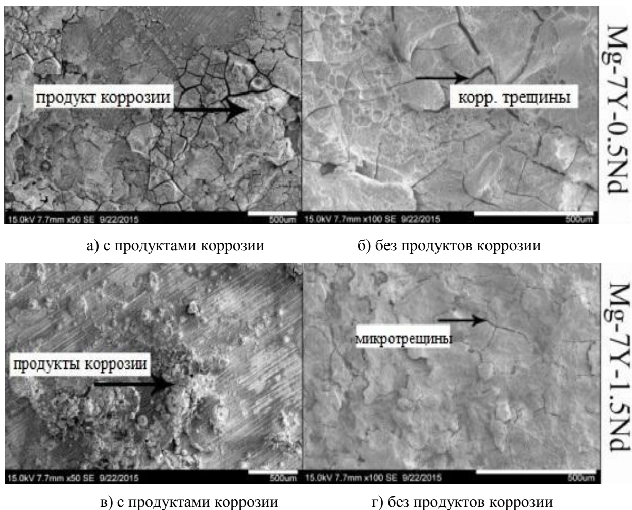
Рисунок 1.3 – Морфология коррозии различных образцов [26]
