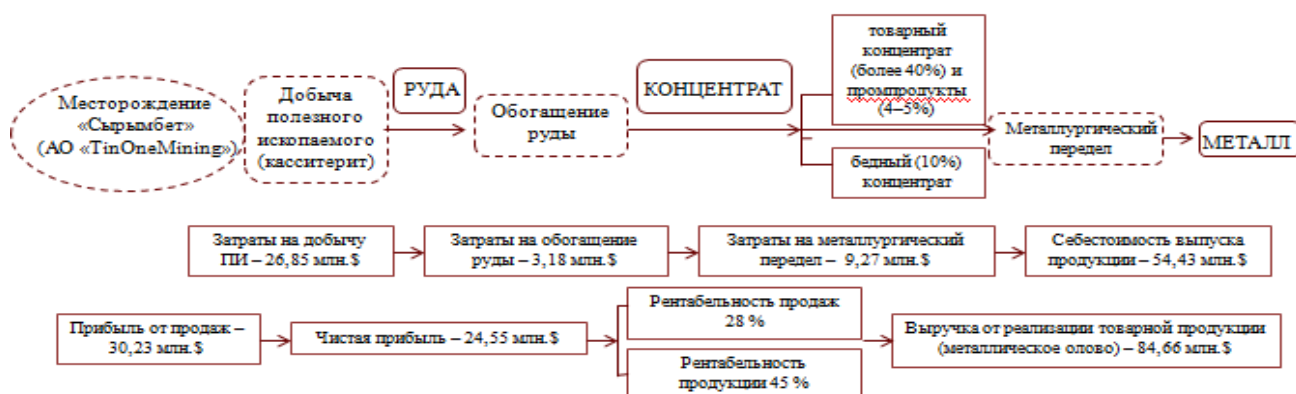
Рисунок 14 – Вариант ЦДС для оловянного производства полного цикла в Республике Казахстан (РК) Источник: составлено автором
