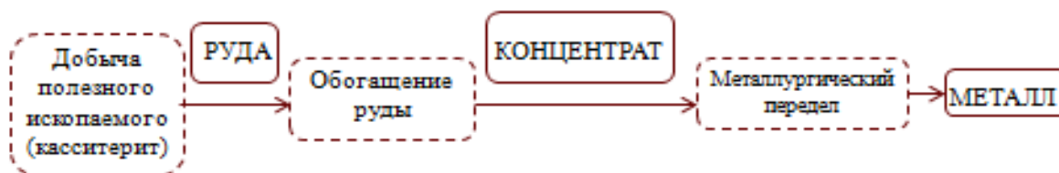
Рисунок 7 – Технологические процессы в оловянном производстве
