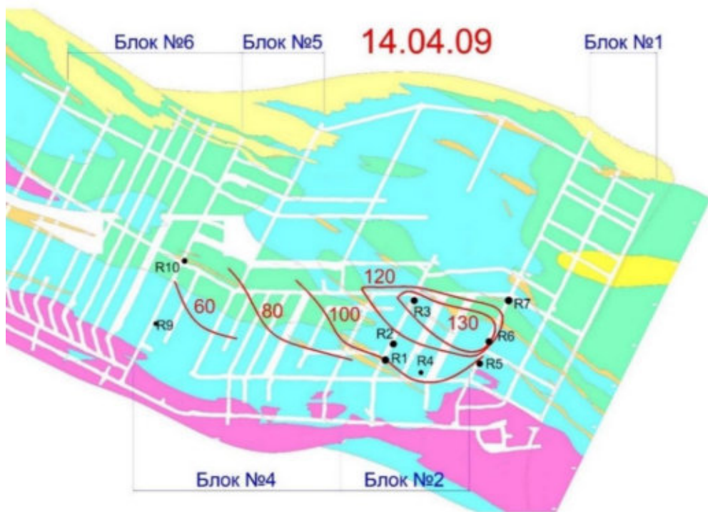
Рисунок 2.29 - Стратоизогипсы осадки рудной потолочины (мм) по результатам наблюдений за реперами №№1-10 на плане горных работ и геологическом разрезе гор. -370 м. Второй год наблюдений
