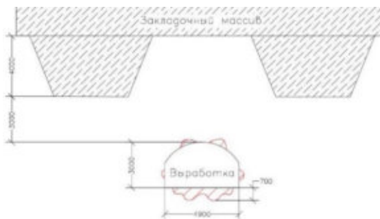
Рисунок 3.23 – Формирование зоны предельного равновесия вокруг очистной выработки в ГГМ рудах средней плотности. Высота очистных выработок: а) - 12 м; б) - 16 м
