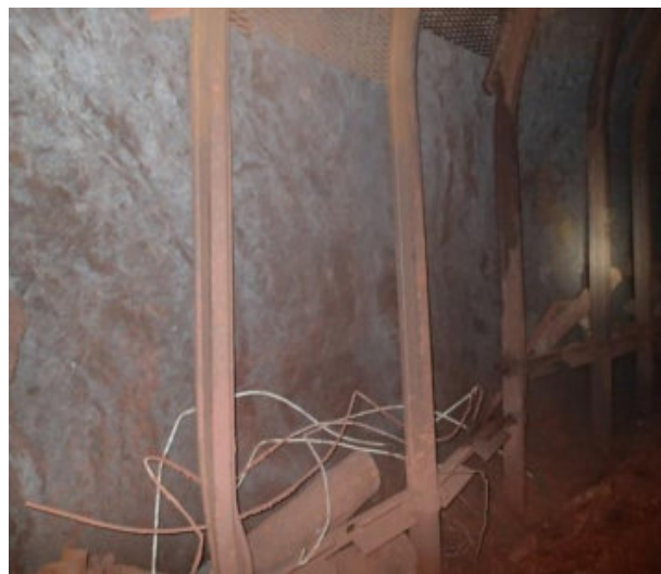
Рисунок 2.19 – Состояние очистной заходки № 6-3-13: а) деформация стойки крепи вследствие вывала; б) отсутствует контакт крепи с массивом порядка 0,4 м
