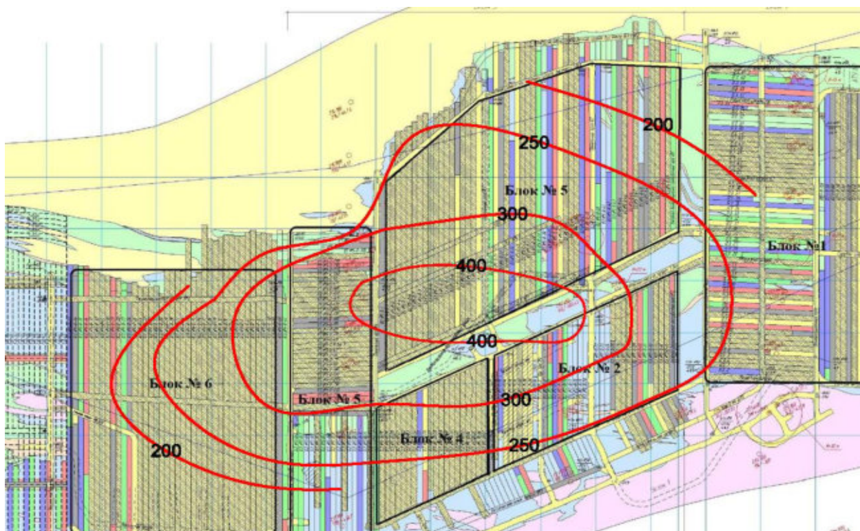
Рисунок 2.31 - Стратоизогиписы оседаний массива (мм) по всем группам реперов на плане горных работ и геологическом разрезе гор. -370 м. Четвертый год наблюдений
