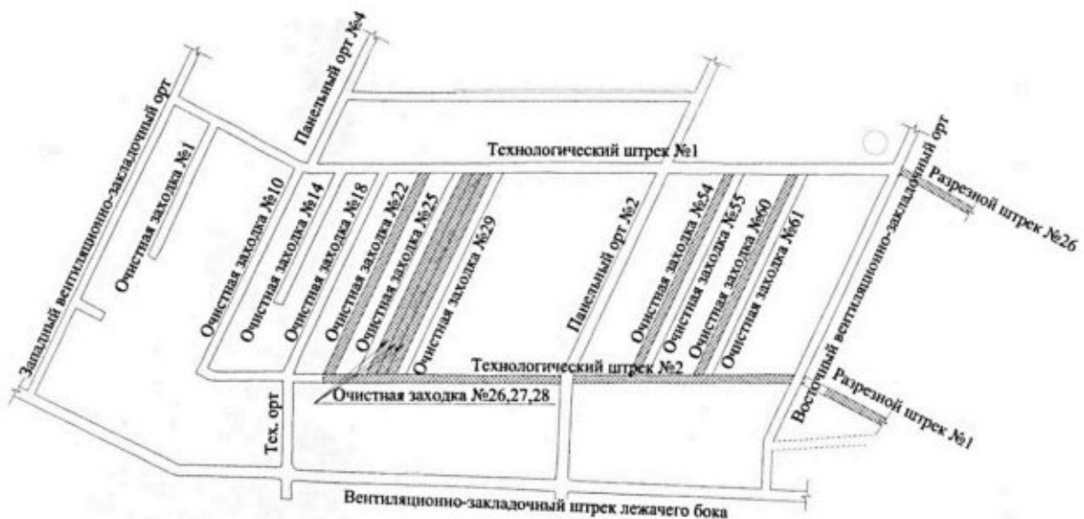
Рисунок 2.10 – План горизонта -370м с указанием контрольных участков горных выработок (ширина разделительного целика равна двум пролетам)
