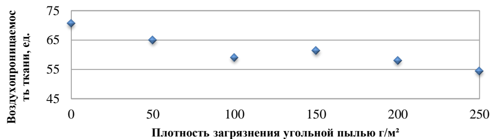
Рисунок 7 - Результаты экспериментального определения воздухопроницаемости материала, используемого для изготовления СИЗ, от плотности загрязнения угольной пылью
