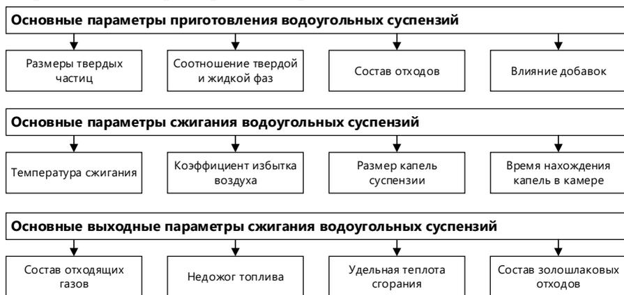
Рисунок 3 – Основные параметры термической утилизации отходов углеобогащения
